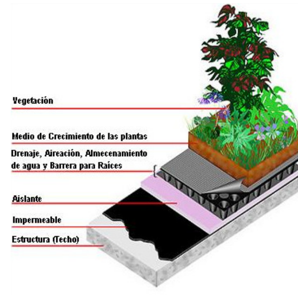
Detalle de azotea verde.
