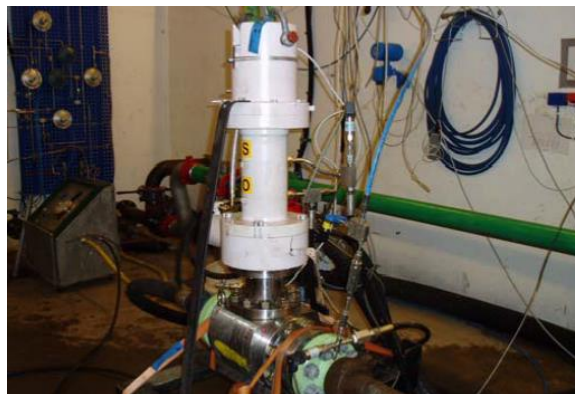
Figura 36. Prueba de válvulas para el manejo de arena 12
