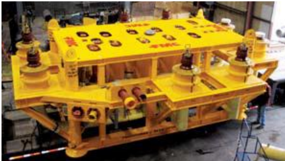
Figura 5. Manifold en Anadarko Genghis Khan propiedad de FMC Technologies 20
