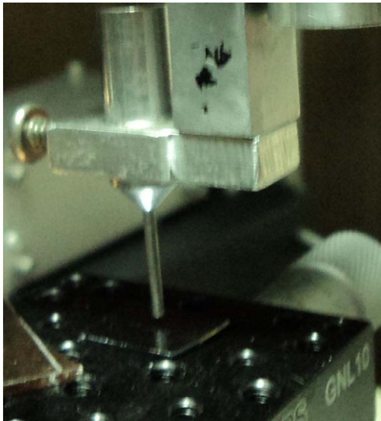
Figura 1.3: Foto de la punta resonante y la muestra que analiza el microscopio de barrido.
