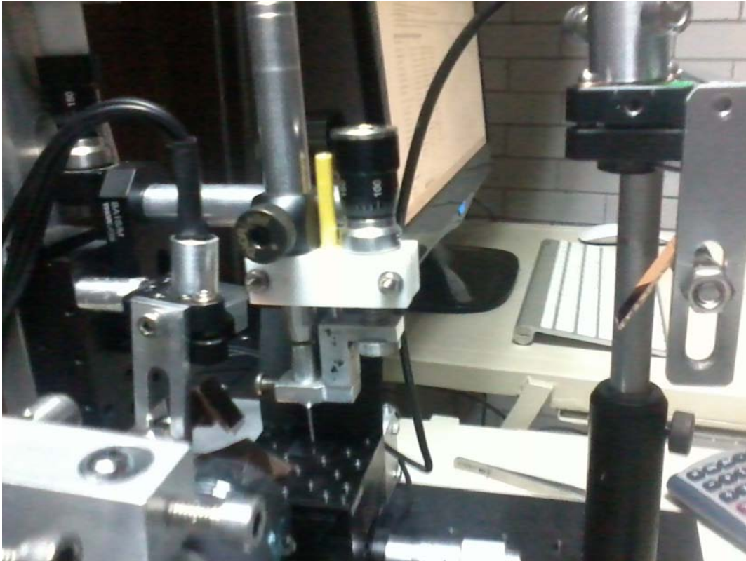
Figura 3.6: Estructura mecánica con láser y fotodiodo integrado a microscopio.
