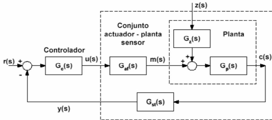
**Figura 5. 11 Nomenclatura en un diagrama de bloques.**
