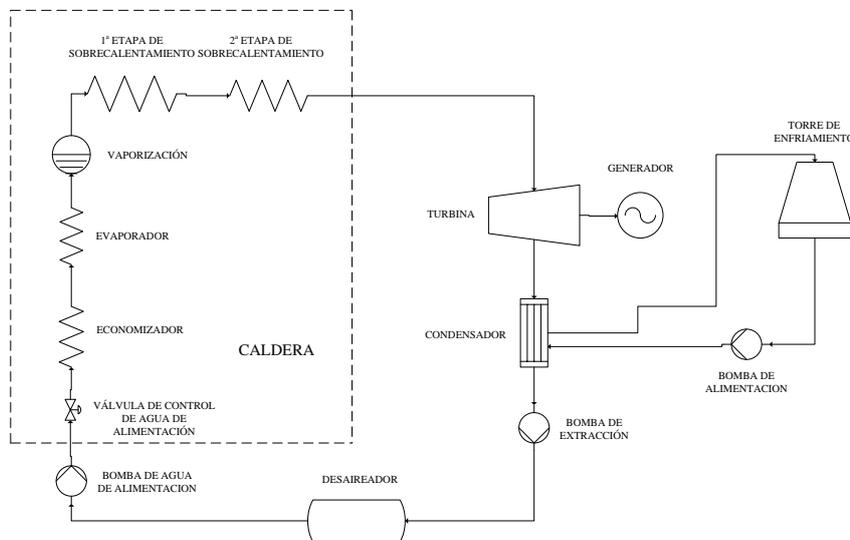
**Figura 4. 1 Circuito de agua de alimentación.**
