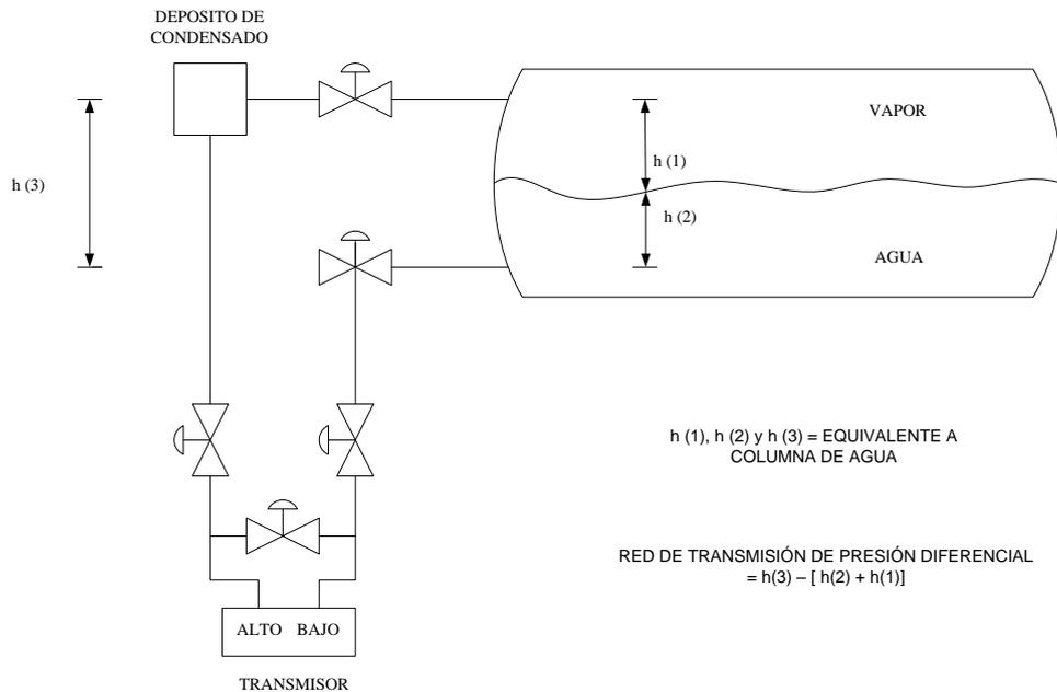
**Figura 5. 26 Arreglo de transmisor diferencial de presión.**
