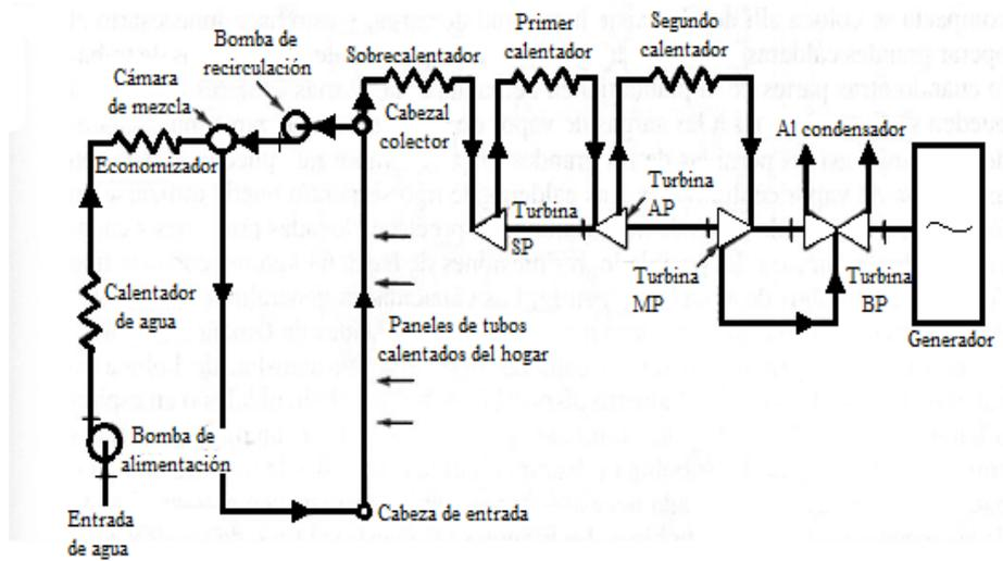
**Figura 1. 29 Dispositivo caldera-turbina usando recirculación forzada.**
