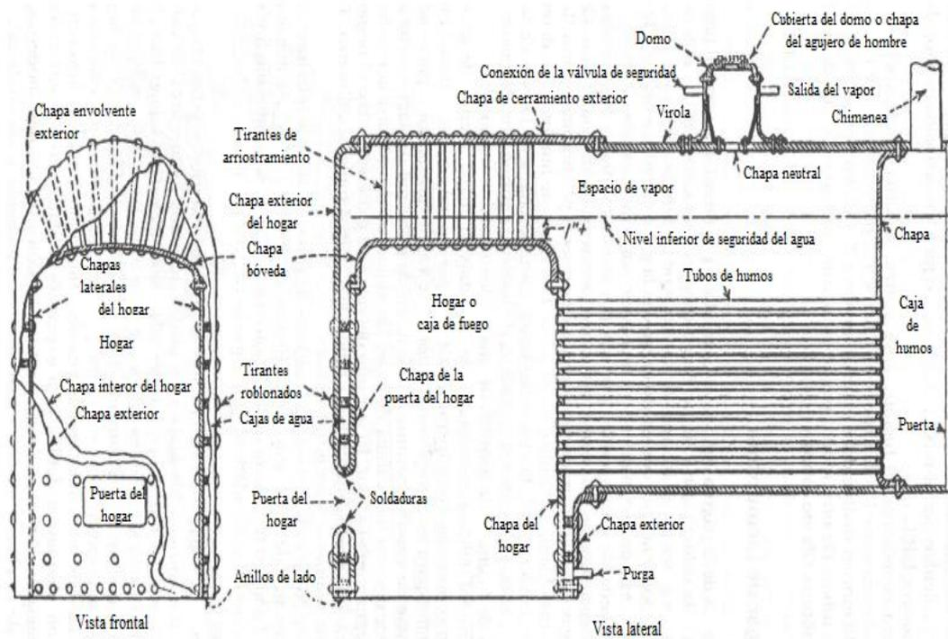
**Figura 1. 17 Caldera de locomotora.**
