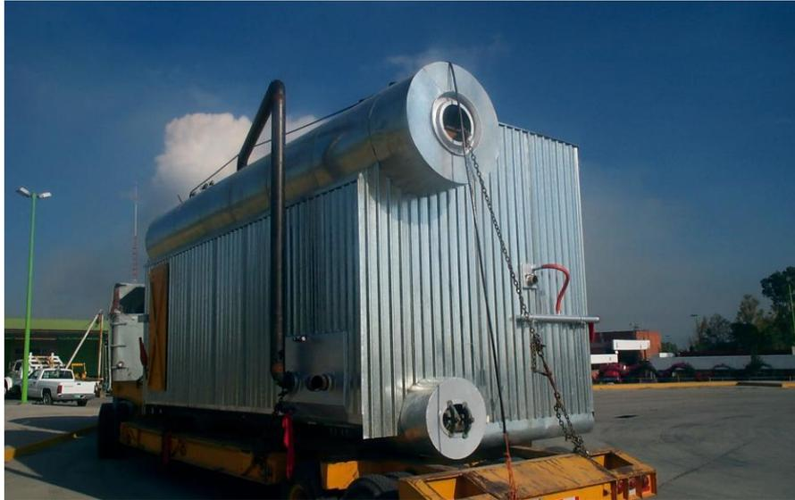
**Figura 2. 1 Caldera de paquete con hogar refrigerado con agua.**
