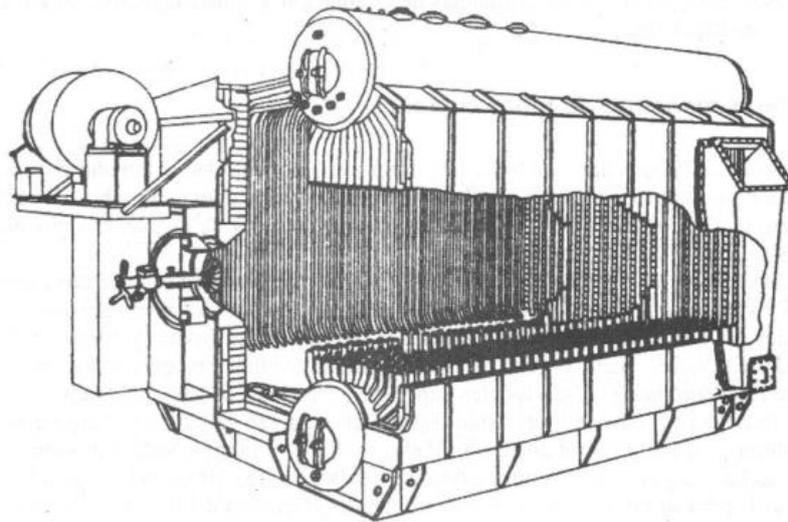
**Figura 1. 24 Caldera tipo D de dos calderines y tubos curvados.**
