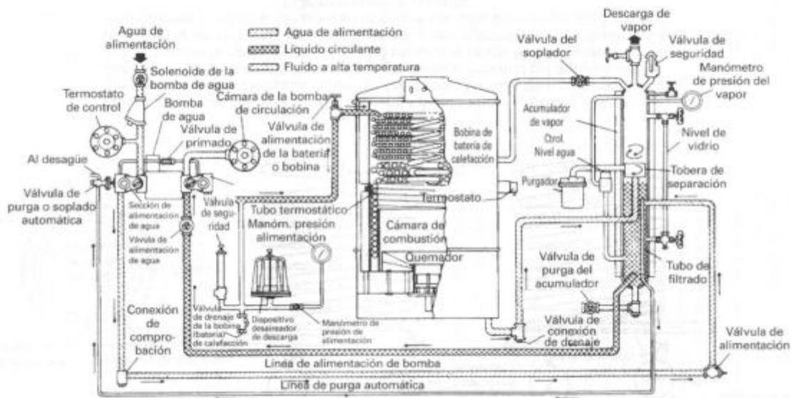
**Figura 1. 30 Caldera de serpentín de tubos de agua mostrando el flujo de agua y vapor.**
