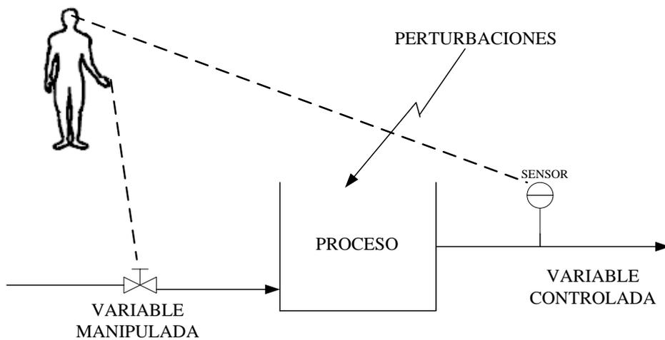
**Figura 5. 6 Lazo de control cerrado realimentado.**
