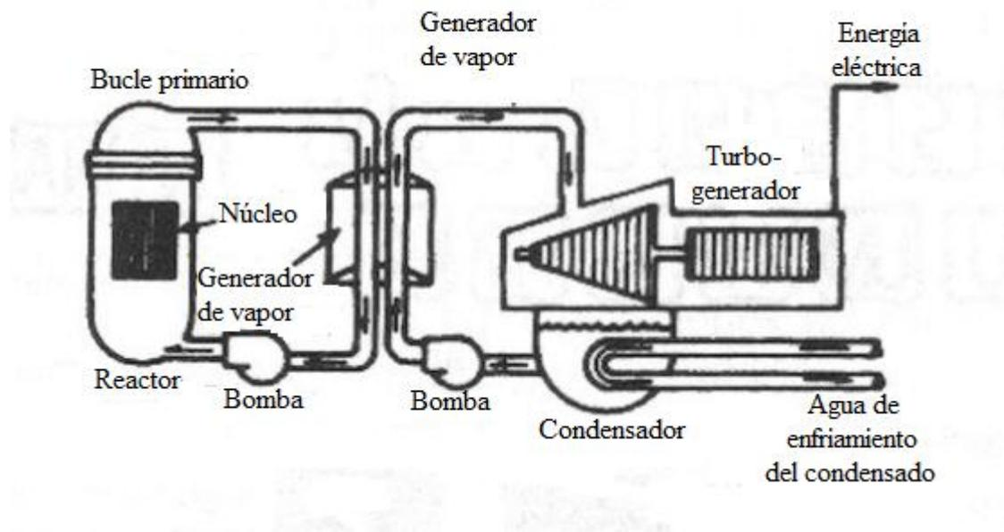
**Figura 1. 15 Reactor de energía nuclear de agua presurizada.**
