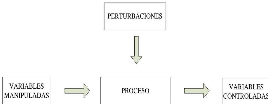
**Figura 5. 5 Esquema de control de proceso.**
