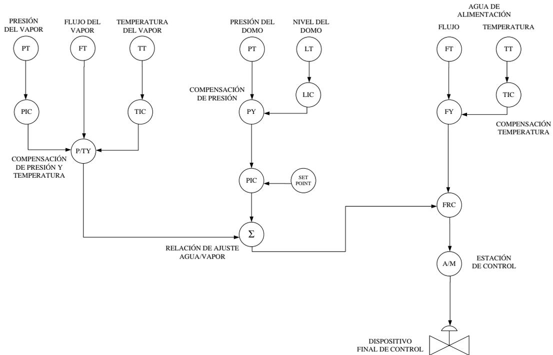
Figura 5. 31 Sistema de control con tres elementos.
