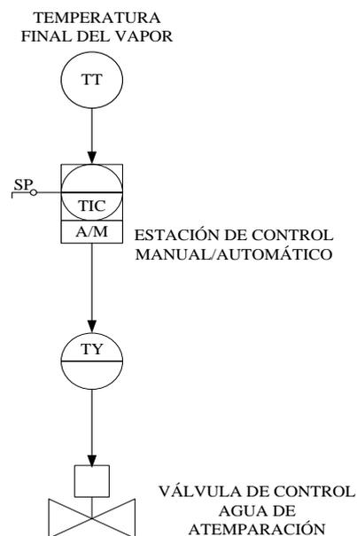
**Figura 5. 33 Sistema de control con un elemento.**
