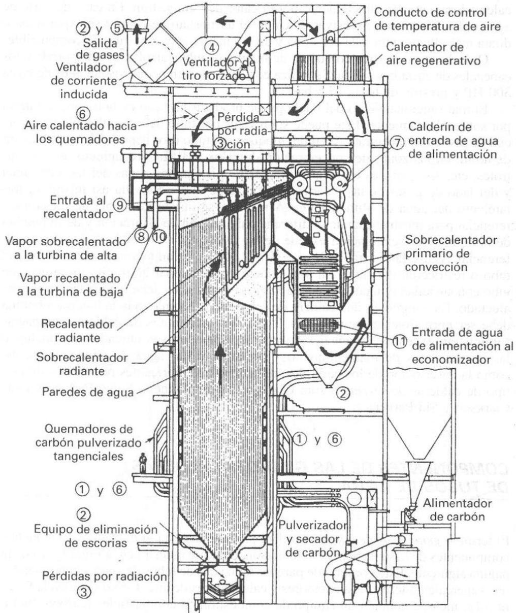
**Figura 1. 31 Componentes de un gran generador de vapor.**
