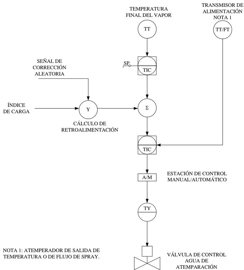
**Figura 5. 35 Sistema de control de temperatura del vapor con tres elementos.**
