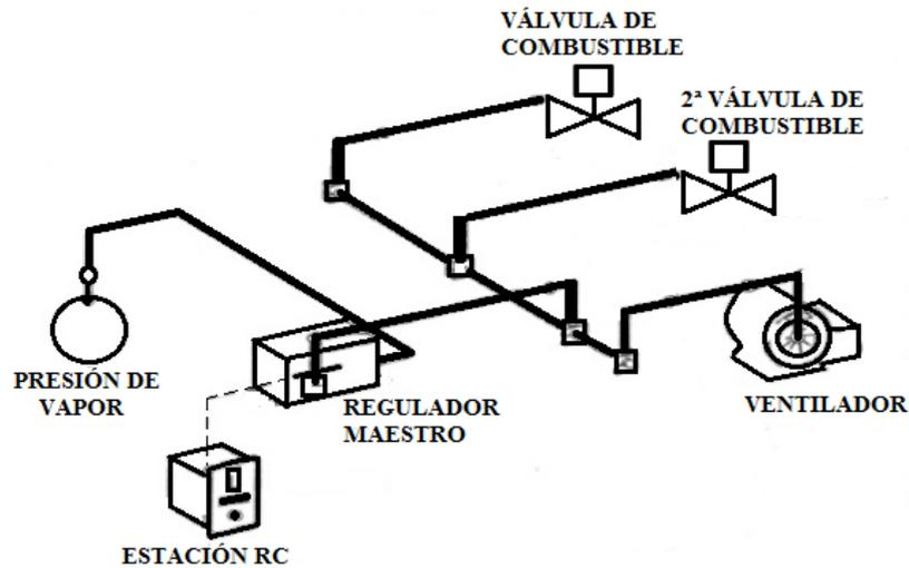
**Figura 5. 15 Sistema de control combustible/aire.**
