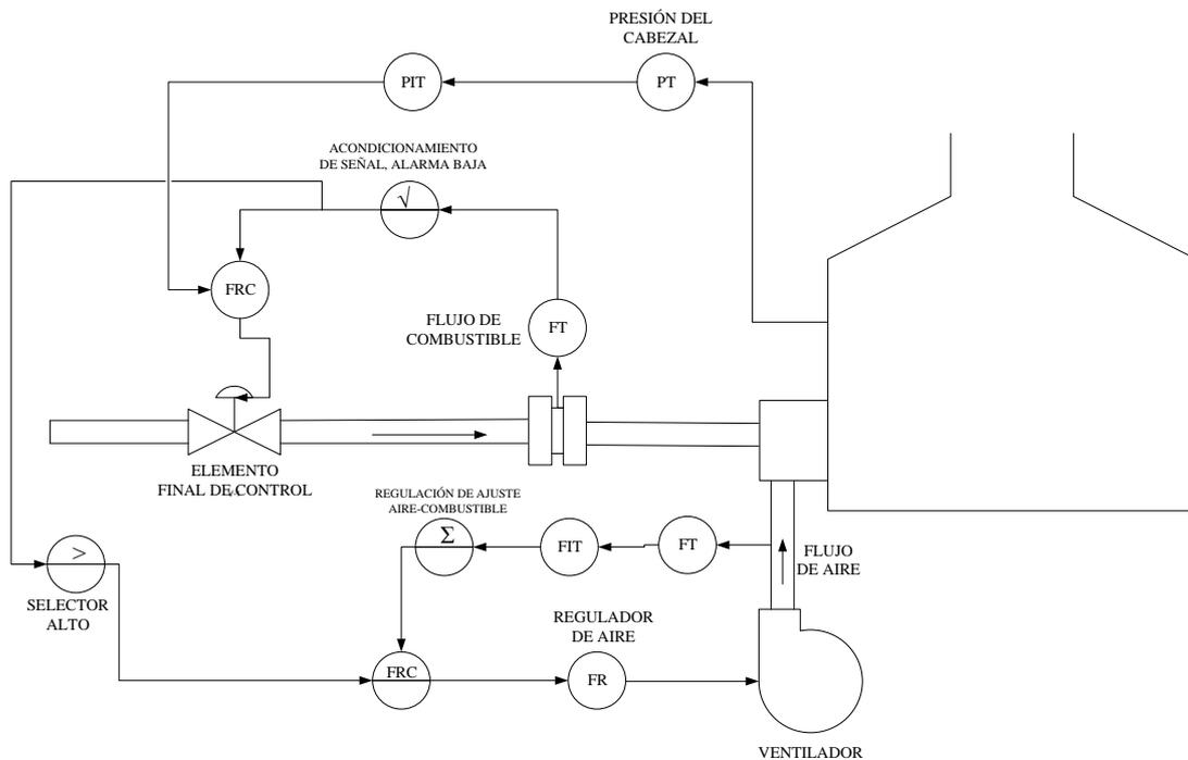
**Figura 5. 19 Sistema de control paralelo aire combustible.**
