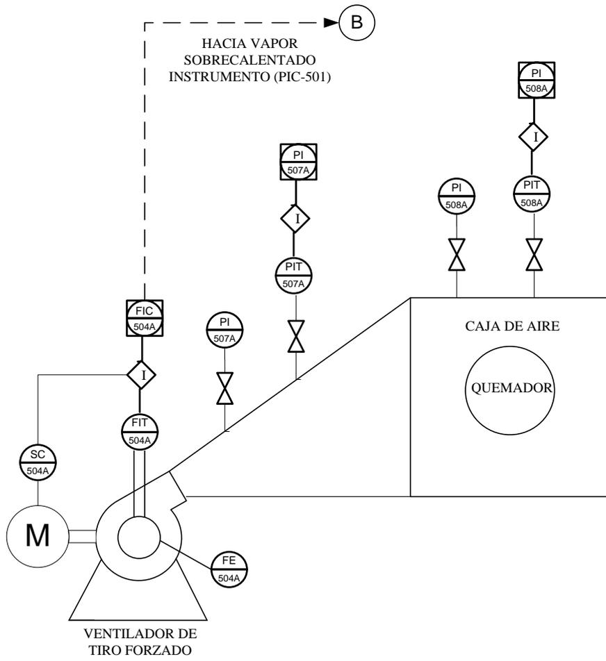
Figura 7. 5 Control de aire de alimentación.
