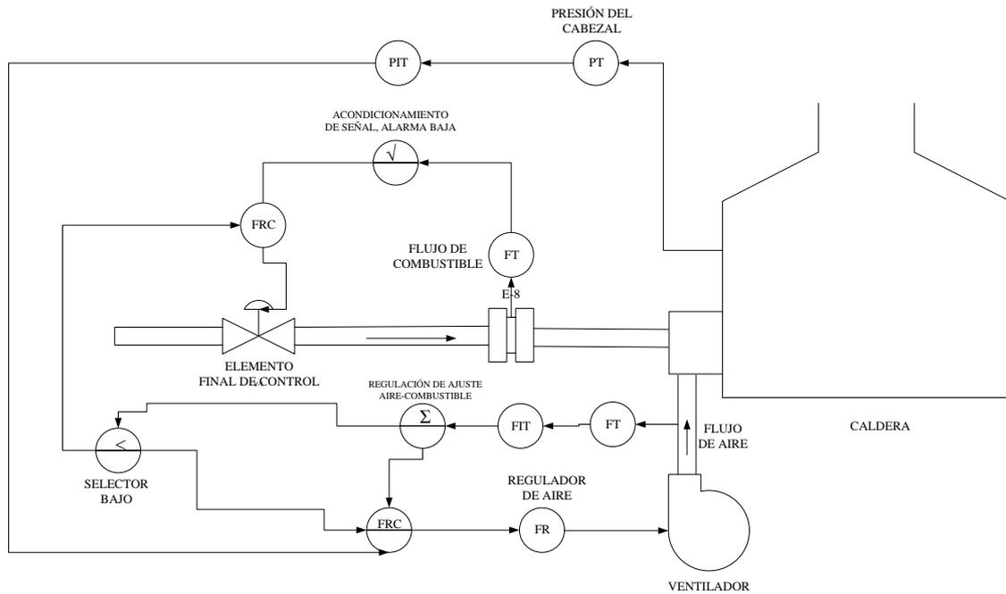
**Figura 5. 20 Sistema de control paralelo con interlock en combustible.**
