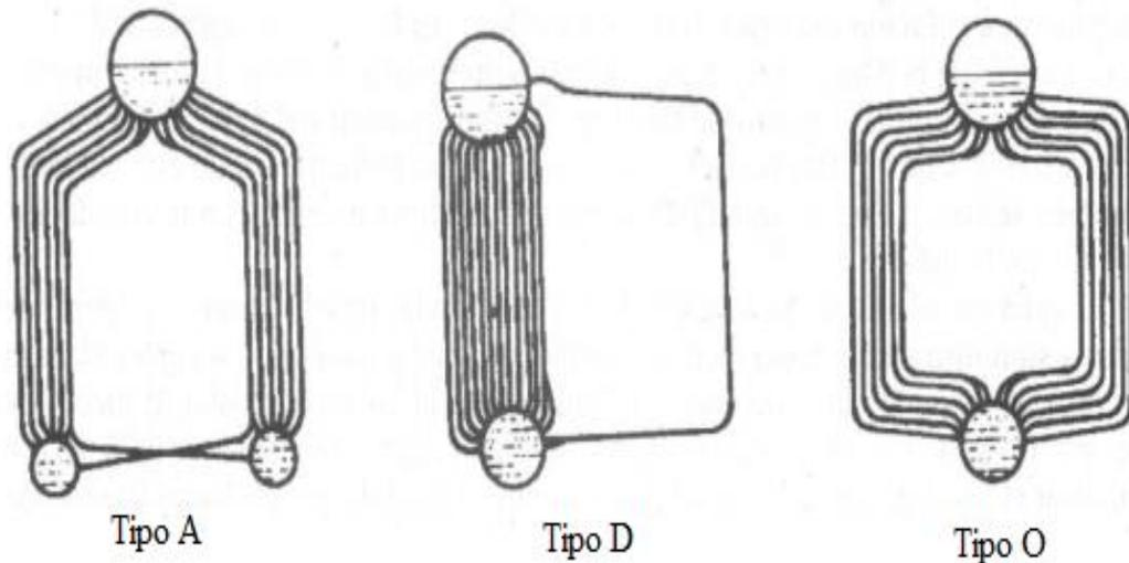
**Figura 1. 23 Diseño de calderas de tubos de agua modelos A, D y O.**
