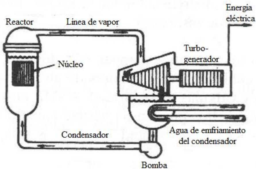
**Figura 1. 14 Reactor de energía nuclear de agua en ebullición.**
