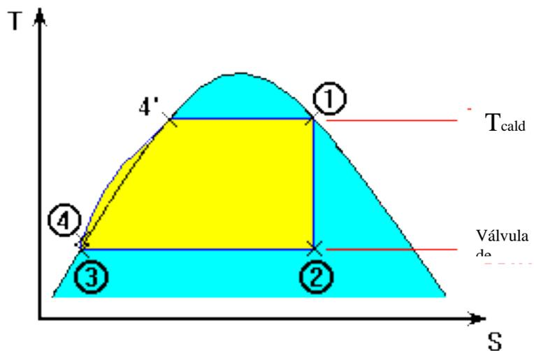
**Figura 1. 10 Diagrama T-S ciclo de vapor cerrado o Rankine.**
