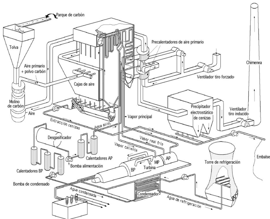
**Figura 2. 2 Planta generadora de energía que quema carbón.**
