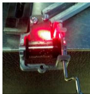
Figura 31. Caja de música compuesta por un peine y un rodillo que gira y golpea las láminas al girar la manivela, poniéndolas a vibrar.
