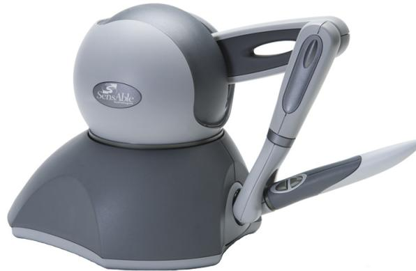
Figura 1.2: Robot *Omni Phantom* de *Sensable*
