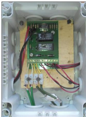
**Figura 2.6: Circuito comparador y caja hermética (el diagrama del circuito se encuentra en el apéndice J).**
