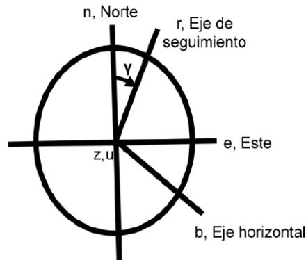
Figura 1.13. Seguimiento solar en un eje horizontal [19].
