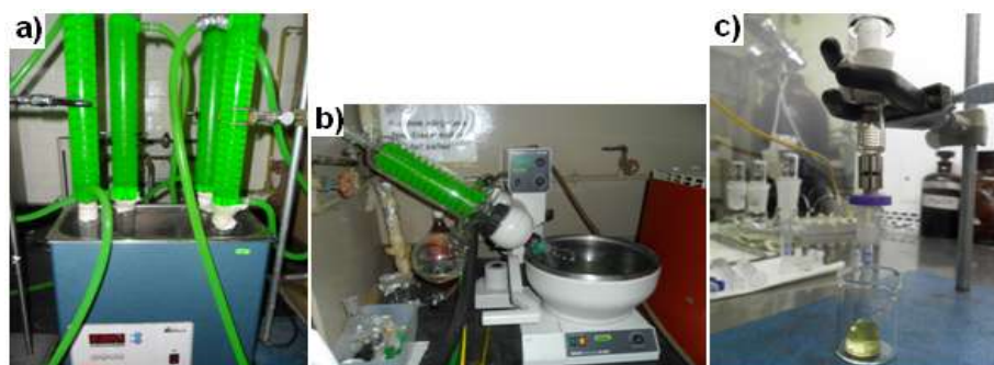
Figura C1. a) Extracción, b) Reducción y c) Filtración y aforo
