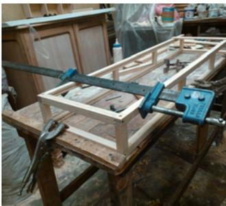
Fig. 60 Proceso de fabricación del tercer prototipo.
