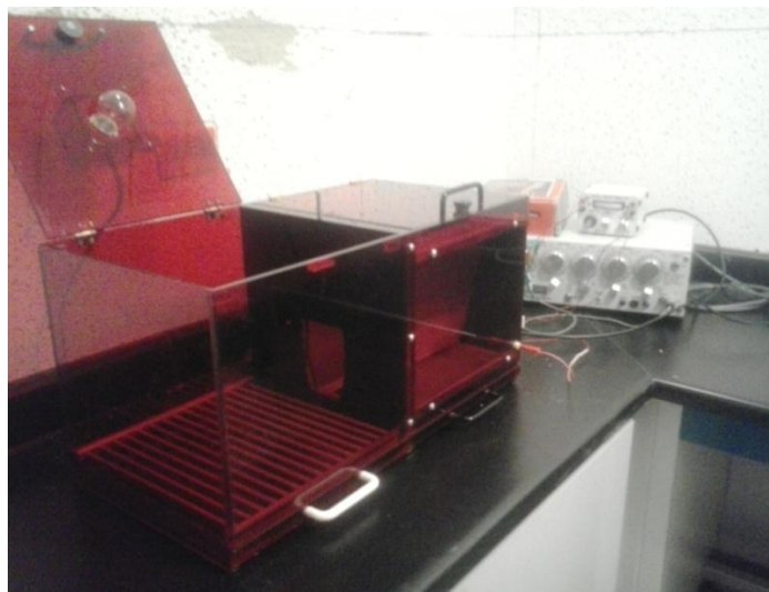
Figura. 8. Caja de evitación inhibitoria conectada al estimulador y el contador automático.
