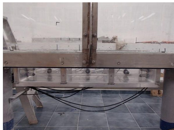
Fig. 4.3 Charola para la colocación del suelo dentro del canal de oleaje (acotaciones en cm)
