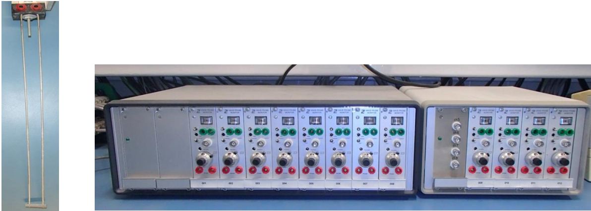
Fig. 4.4 Sensor de nivel (izquierda) y Monitores para los sensores de nivel (derecha)
