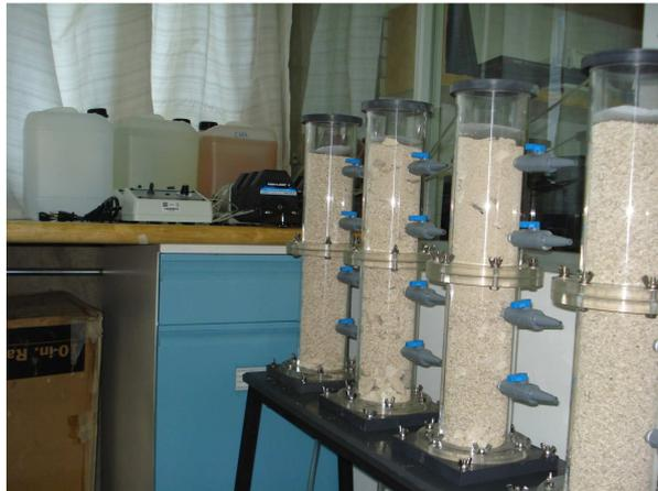
**Figura 8.30** Columnas que simulan un sistema de tratamiento pasivo (barrera geoquímica) rellenas con roca KIT1 y listas para comenzar a funcionar.
