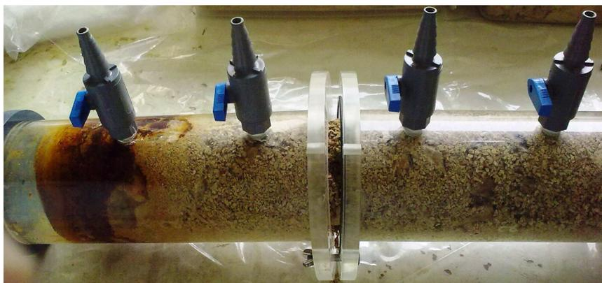
**Figura 8.36** Desensamble de una de las columnas de tratamiento de lixiviados de SMN, la tonalidad roja se debe a la formación de precipitados en esa parte de la columna.
