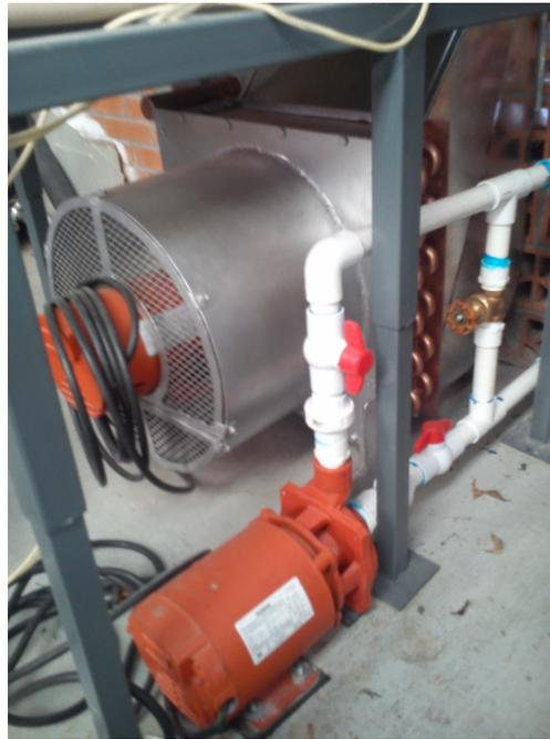
Figura 3.16: Fotografía del radiador y la bomba utilizados en el sistema de acondicionamiento del agua de condensación.
