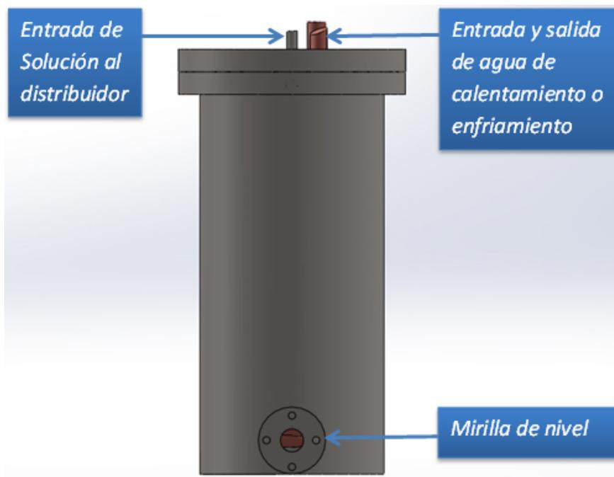
Figura 3.4: Dibujo esquemático del intercambiador utilizado como absorbedor o generador.
