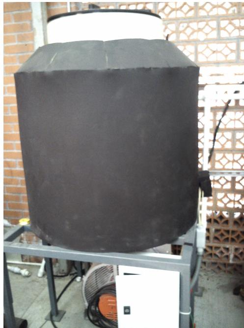
Figura 3.17: Fotografía del montaje del tanque de almacenamiento utilizado en el sistema de acondicionamiento del agua de condensación.
