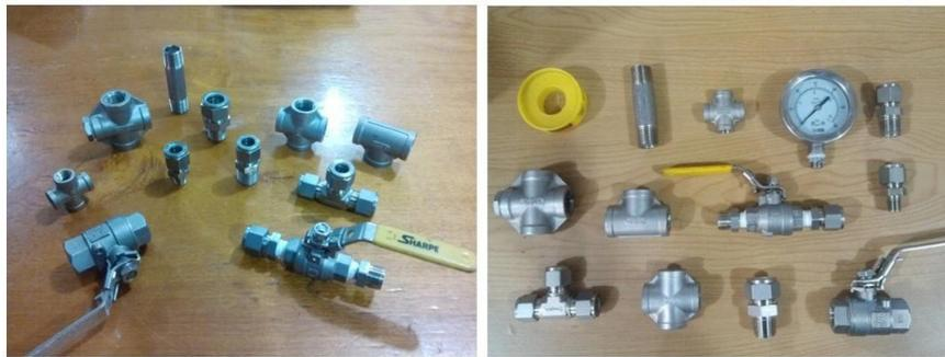
Figura 3.11: Tipos de accesorios utilizados en la interconexión de componentes y sensores
