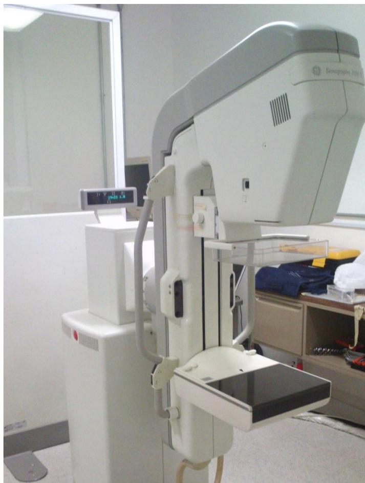
Figura 3.1-1. Senographe 2000D. El detector del mastógrafo es de conversión indirecta, basado en ioduro de cesio dopado con talio (CsI:Tl).
