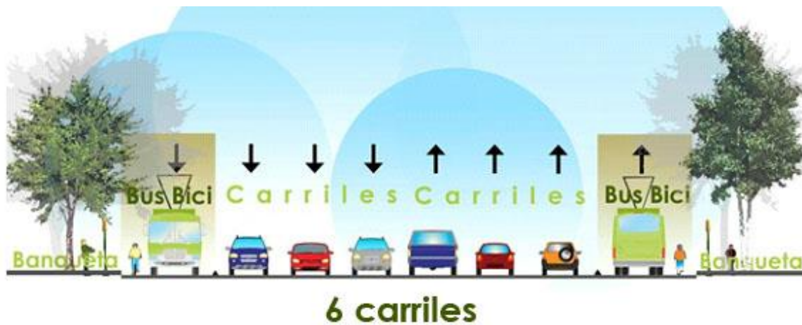
Figura 62 Corte objetivo de línea E, tramo Eje 2 Oriente Calzada La Viga – Periférico Canal de Garay
