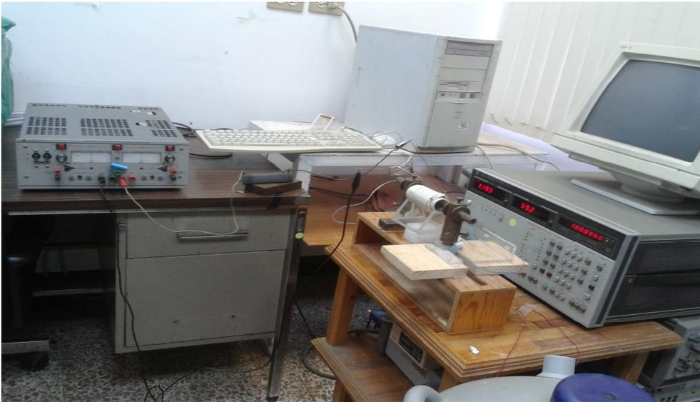
Fig. B1. Esquema de conexión del equipo para medir espectroscopia de impedancia.
