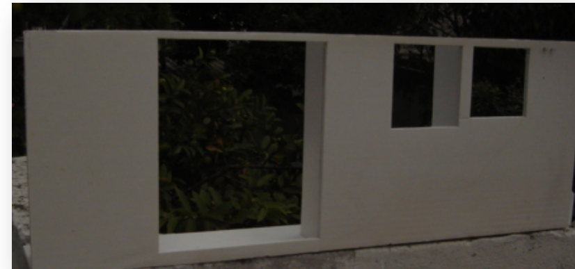
Imagen de la maqueta escala 1:10, donde se reproducen las medidas de los vanos del edificio analizado © Daniel E. García Flores.
