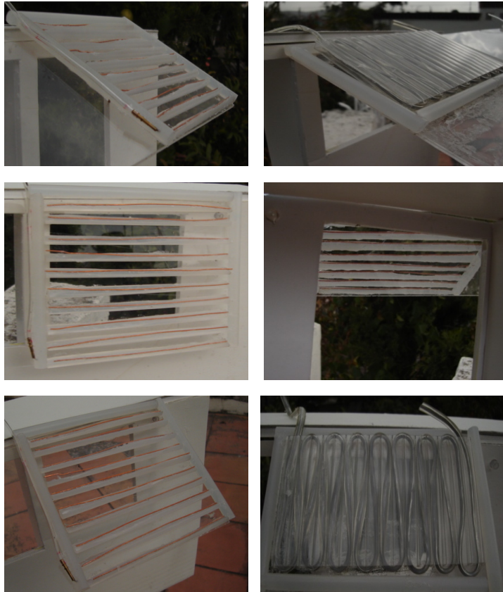
Imágenes de los modelos 1:10 de los colectores solares, realizados por el autor. © Daniel E. García Flores.
