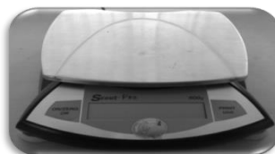
Figura 20. Balanza semianalitica utilizada para la determinación de la pérdida de peso
