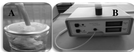
Figura 22. (A) Sistema cerrado con fruto adentro, (B) Analizador de CO 2 utilizado para medir la intensidad respiratoria.
