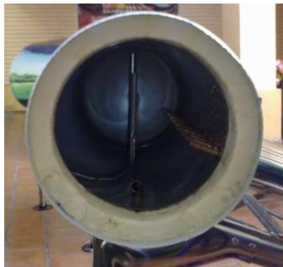
Figura 2.8. Corte transversal de un termotanque de un calentador de tipo Heat Pipe. 1
