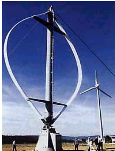
Figura 4.3. Ejemplo de aerogeneradores de eje horizontal (Derecha) y de eje vertical del tipo Darrieus (Izquierda). 1
