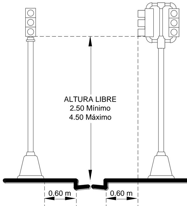
Figura 3.1 Semáforo con soporte tipo poste.
