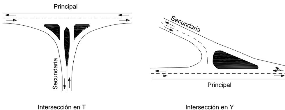
Figura 4.7 Intersecciones de tres ramales.
