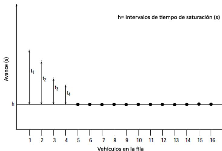
Figura 6.1 Intervalos de tiempo de flujo de saturación y tiempo perdido.
