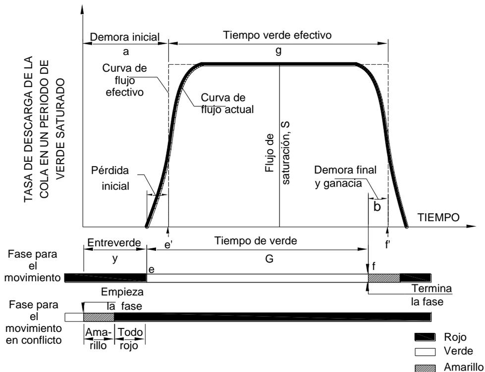
Figura 6.2 Modelo básico del flujo de saturación.
