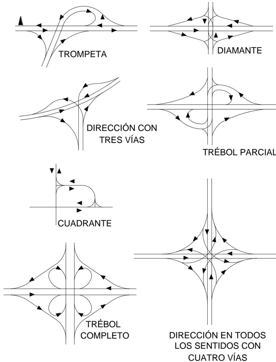
Figura 4.1 Intersecciones a desnivel.
