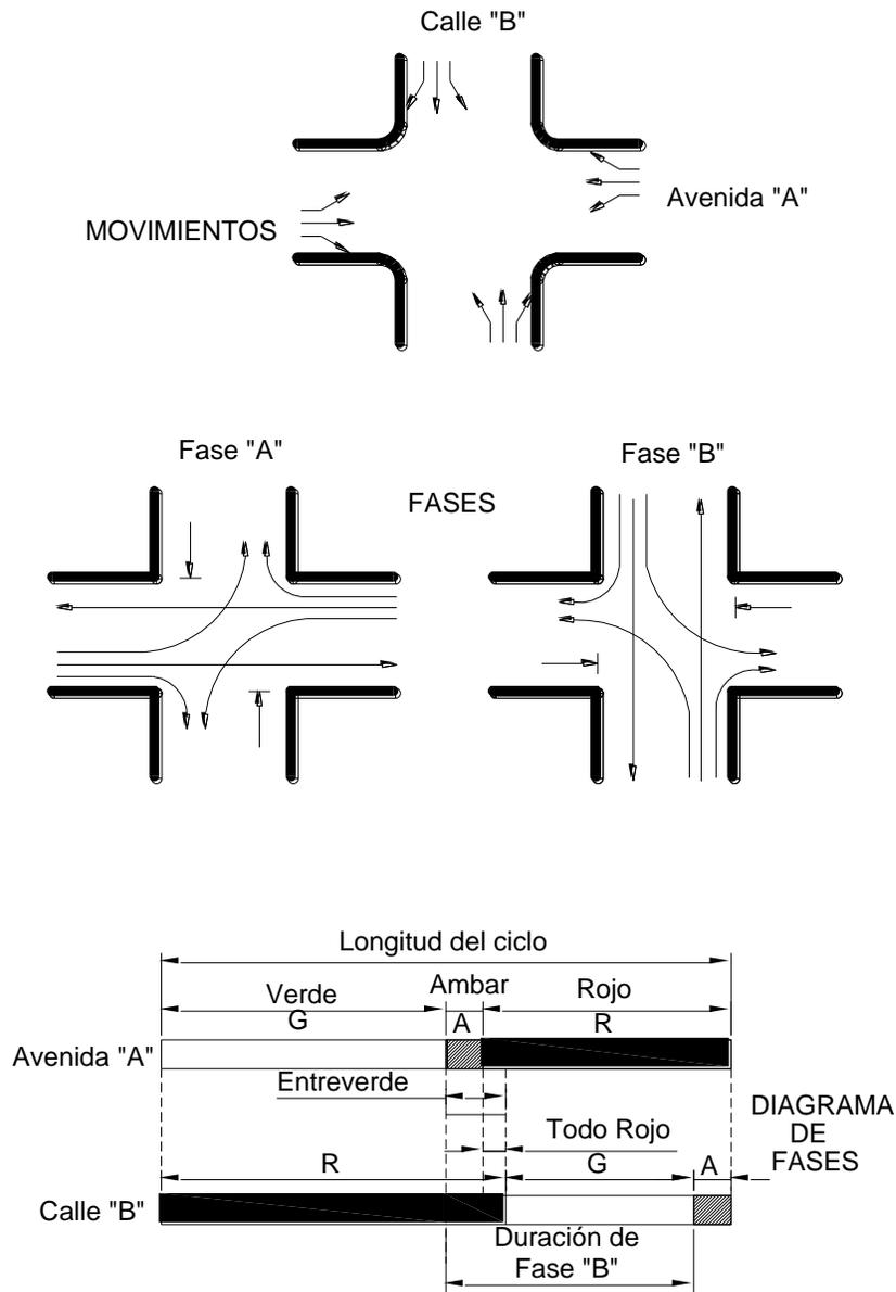
Figura 3.4 Fases y diagrama de fases en una intersección con semáforo.
