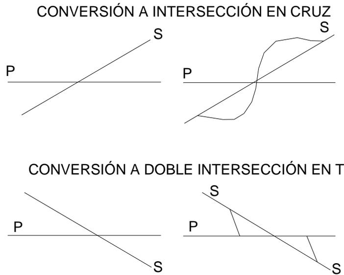
Figura 4.11 Formas correctas de convertir intersecciones en X.
