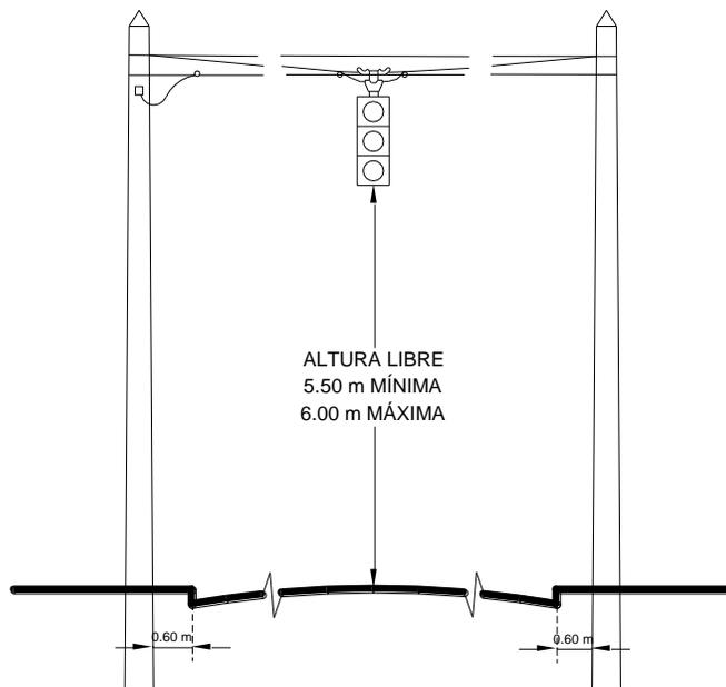
Figura 3.3 Semáforo suspendido por cable.
