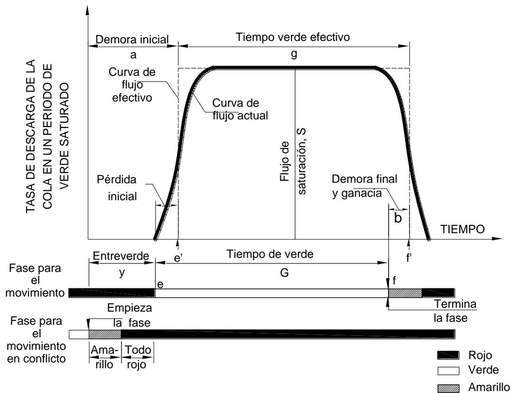
Figura 3.6 Modelo básico del flujo de saturación.
