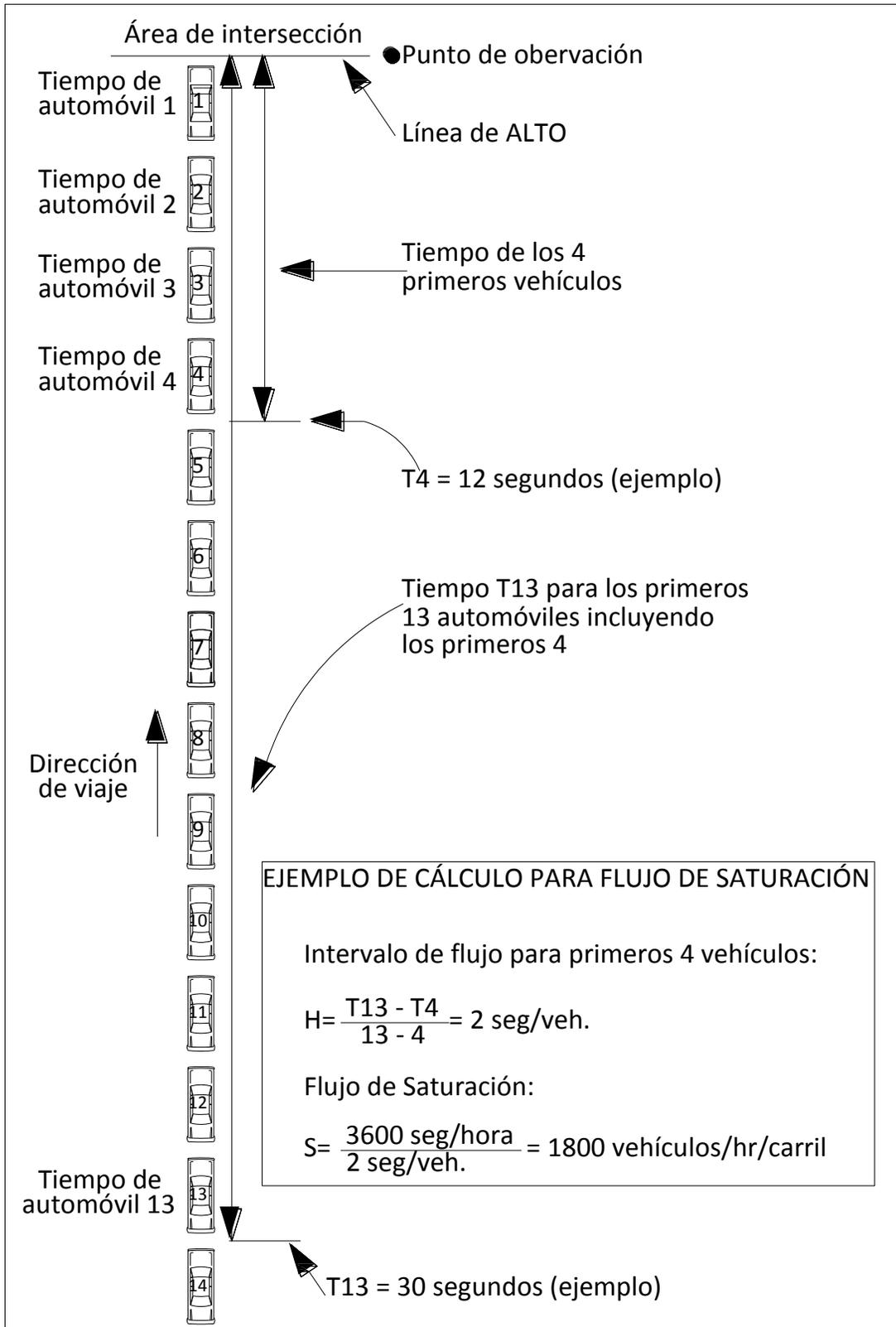
Figura 8.2 Medición del flujo de saturación en campo.
