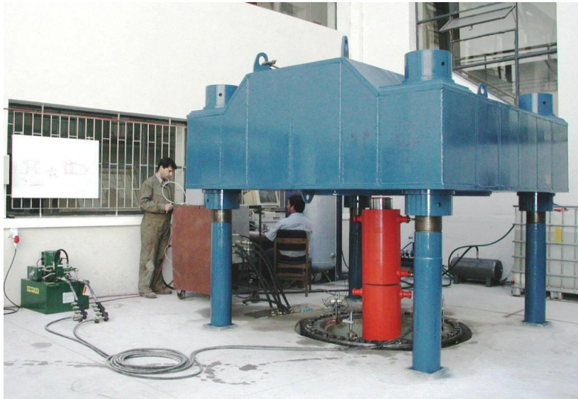
Figura 3.13. Marco de carga. Equipo triaxial gigante de la Universidad de Chile (Bard et al. , 2007)
