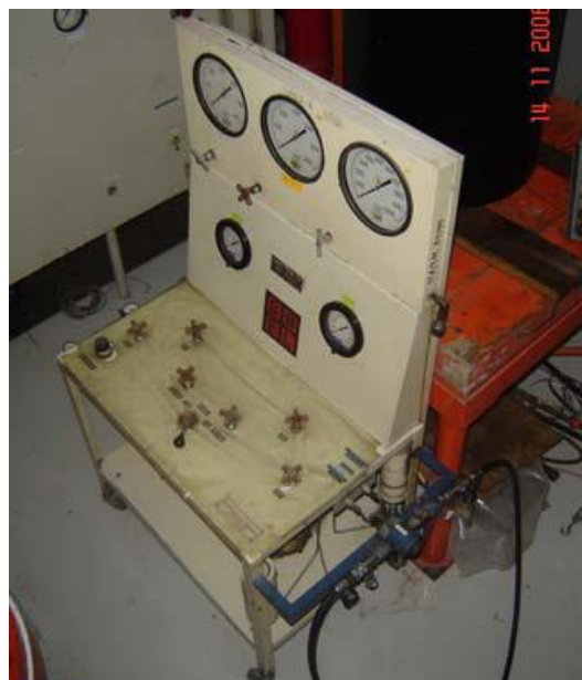
Figura 3.8 Detalle del tablero de manómetros de la cámara triaxial T-30-75 (CFE, 2007)
