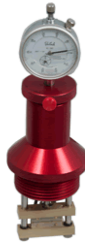
Figura VII-8 Celda utilizada para el montaje de la membrana en el equipo 740-MTS.
