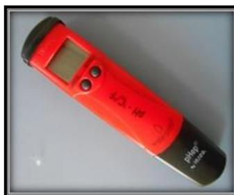
Figura 32. Potenciómetro manual.
