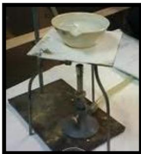
Figura 27. Incineración directa con mechero de Bunsen.
