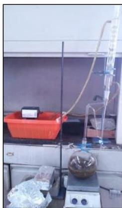
Figura 20. Destilación por arrastre de vapor para la obtención de aceite esencial de orégano.
