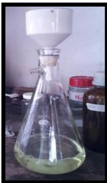
Figura 30. Lavado de la muestra después de la digestión.
