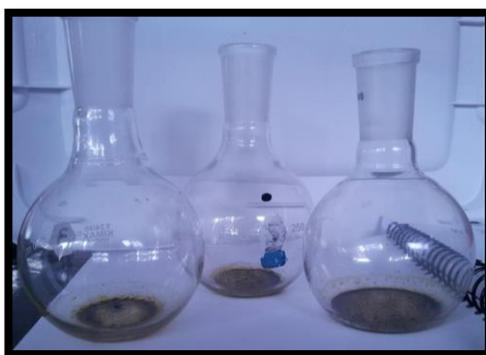
Figura 33. Lípidos en verdolaga hidropónica, extraídos por Soxhlet
