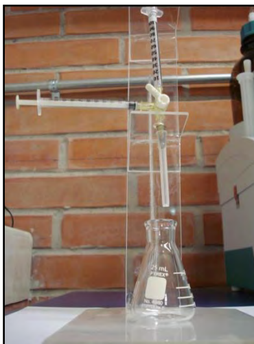
Fig. A3.2. Microbureta utilizada para la determinación del contenido de \text{HCO}_3^- en las muestras obtenidas en la fase inicial de los experimentos de interacción agua-roca.
