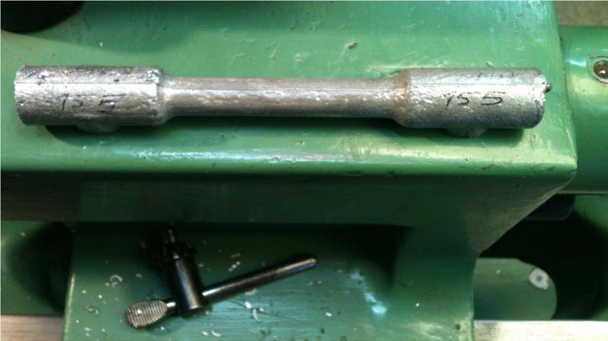
Figura 26. Probeta sin maquinar.
