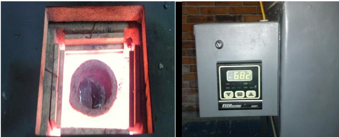
Figura 18. En la figura de la izquierda se muestra el crisol con la carga del material a fundir en la mufla. En la figura de la derecha se observa la temperatura de trabajo.
