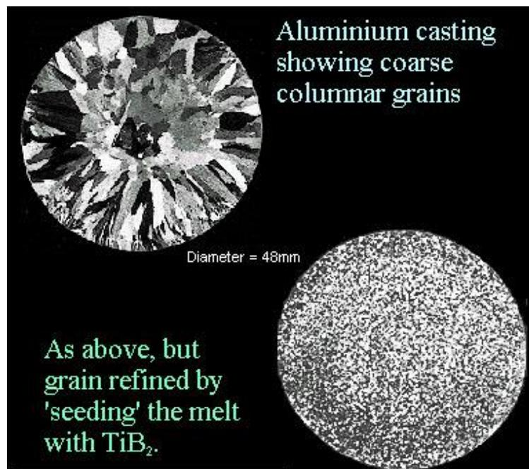
Figura 1. Se muestra el tamaño de grano sin elementos inoculantes y el efecto de refinamiento de grano que causa el inoculante  $TiB_2$ .
