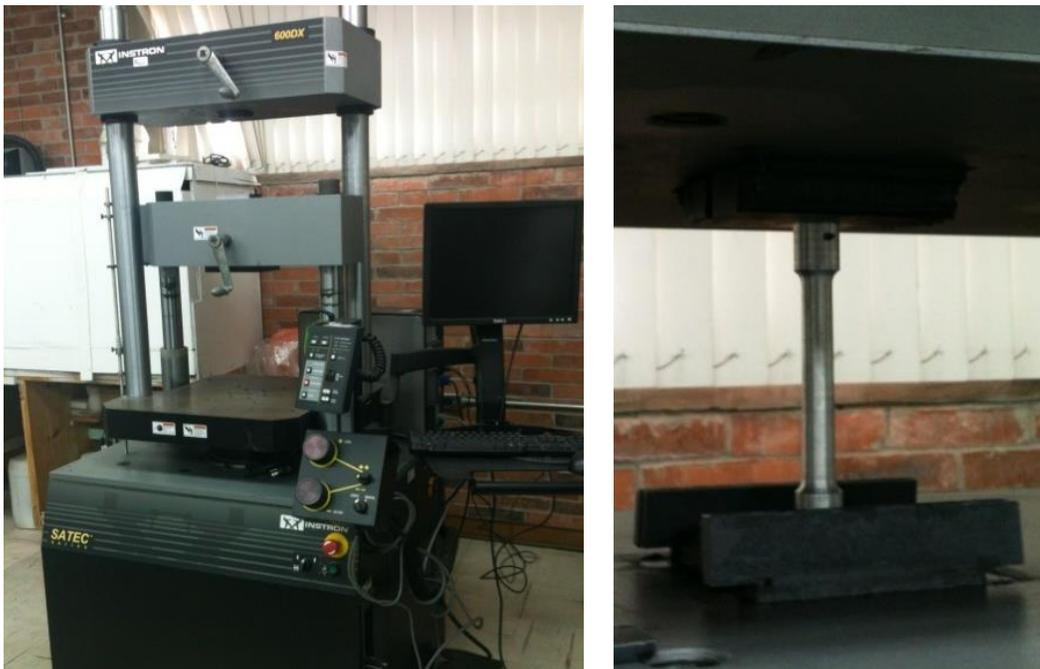
Figura 32. Equipo utilizado para las pruebas de tensión de las probetas.
