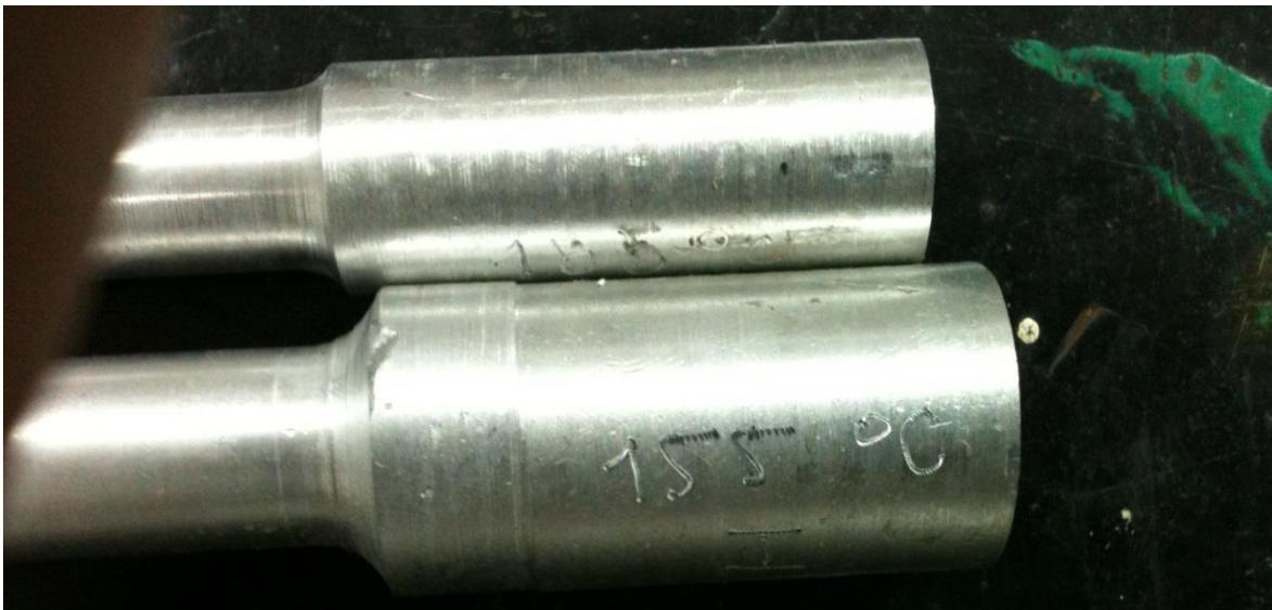
Figura 31. Probetas sometidas a tratamiento termico de envejecimiento artificial a 155°C marcadas.
