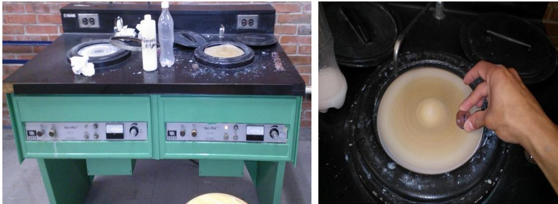
Figura 36. Equipo utilizado para el proceso de pulido de las muestras.
