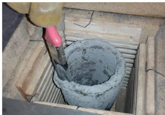
Figura 14. Aplicación de la pintura de grafito al crisol.
