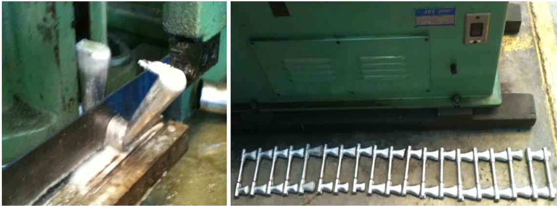
Figura 23. Corte de sección de alimentación.
