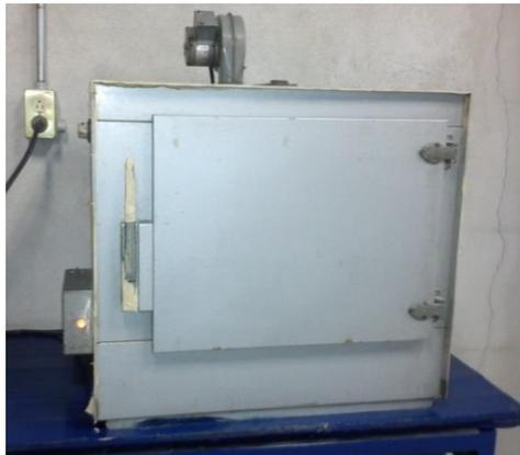
Figura 17. Horno electrico utilizado para el proceso de precalentado de las herramientas y el molde.
