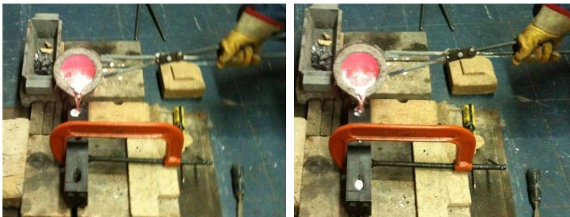
Figura 20. Proceso de vaciado del material fundido en el molde.
