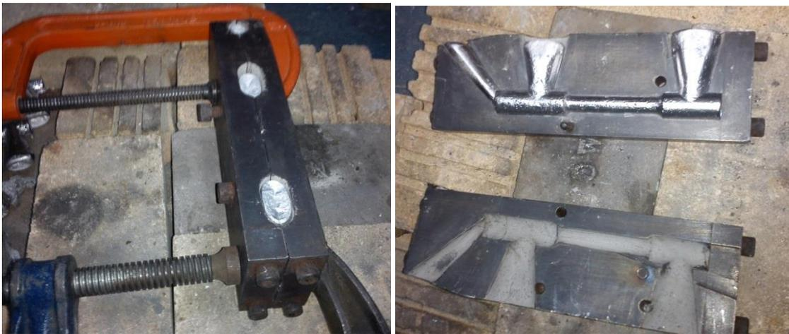
Figura 21. En la figura se observa la probeta solidificada en el molde.
