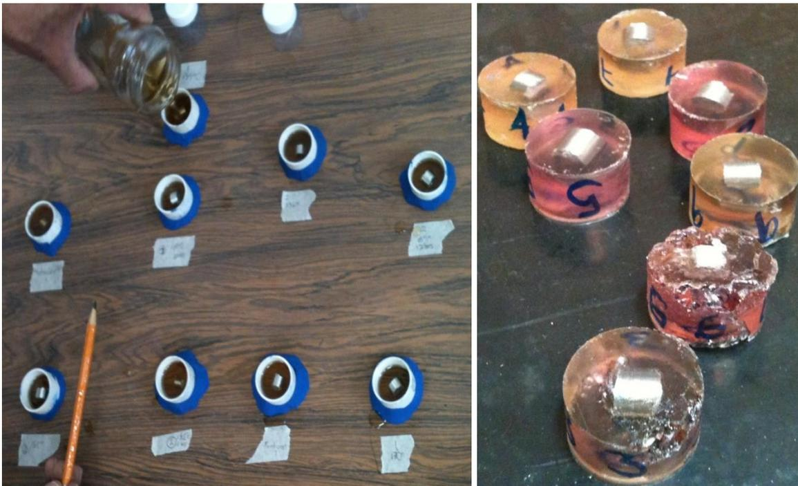
Figura 34. Proceso de montaje de las muestras en resina.
