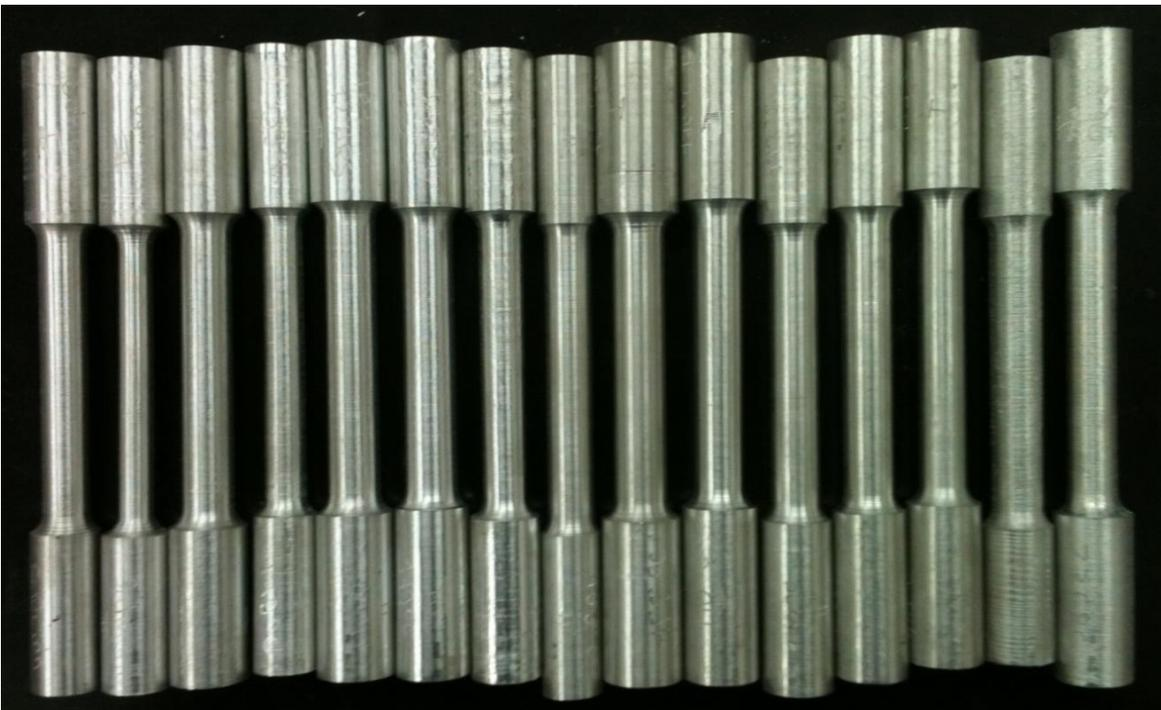
Figura 29. Lote de probetas maquinadas.
