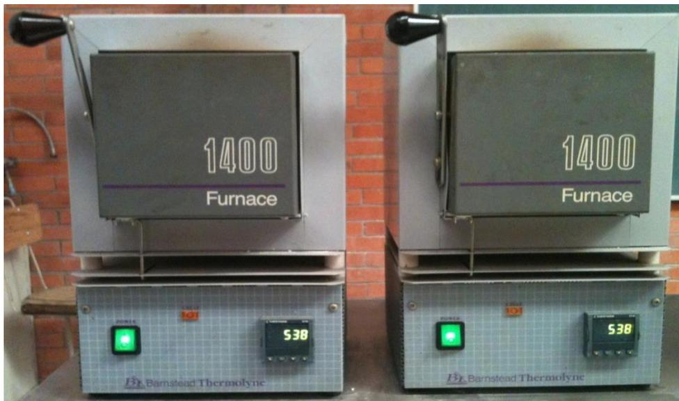
Figura 25. Tratamiento térmico de solución a  $538^{\circ}\text{C}$  de las probetas en hornos eléctricos.
