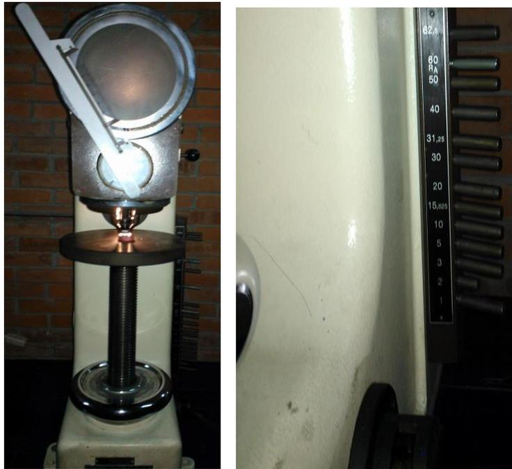
Figura 40. Equipo utilizado para las pruebas de dureza.
