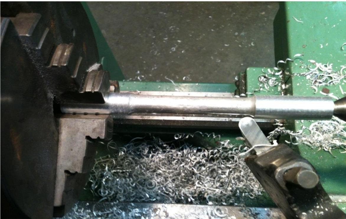
Figura 27. proceso de maquinado de probeta.
