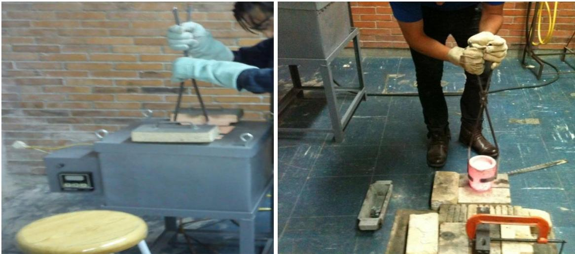
Figura 19. Proceso de extracción del crisol con material fundido.
