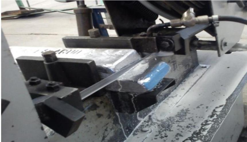
Figura 10. Corte con sierra de banda eléctrica.
