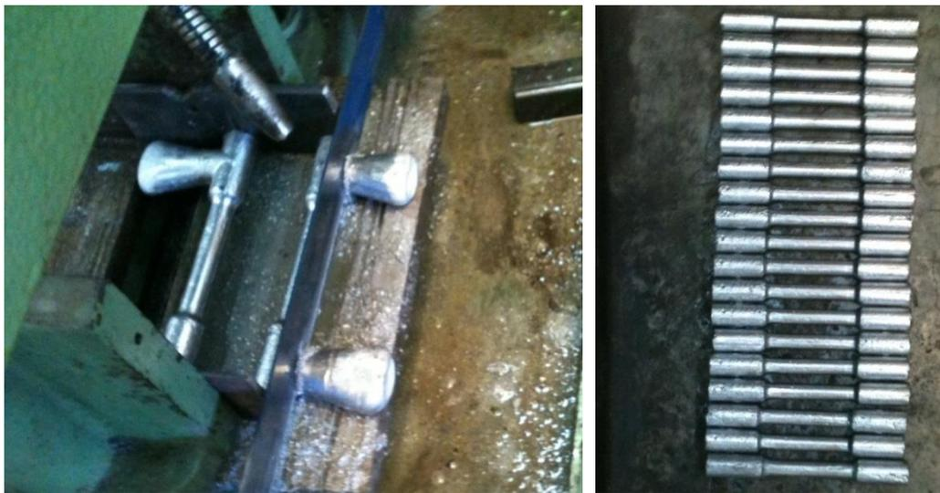
Figura 24. Corte de secciones de alivio.
