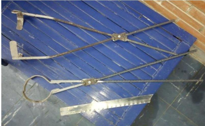
Figura 15. Herramental utilizado para el proceso de extracción y vaciado del crisol.
