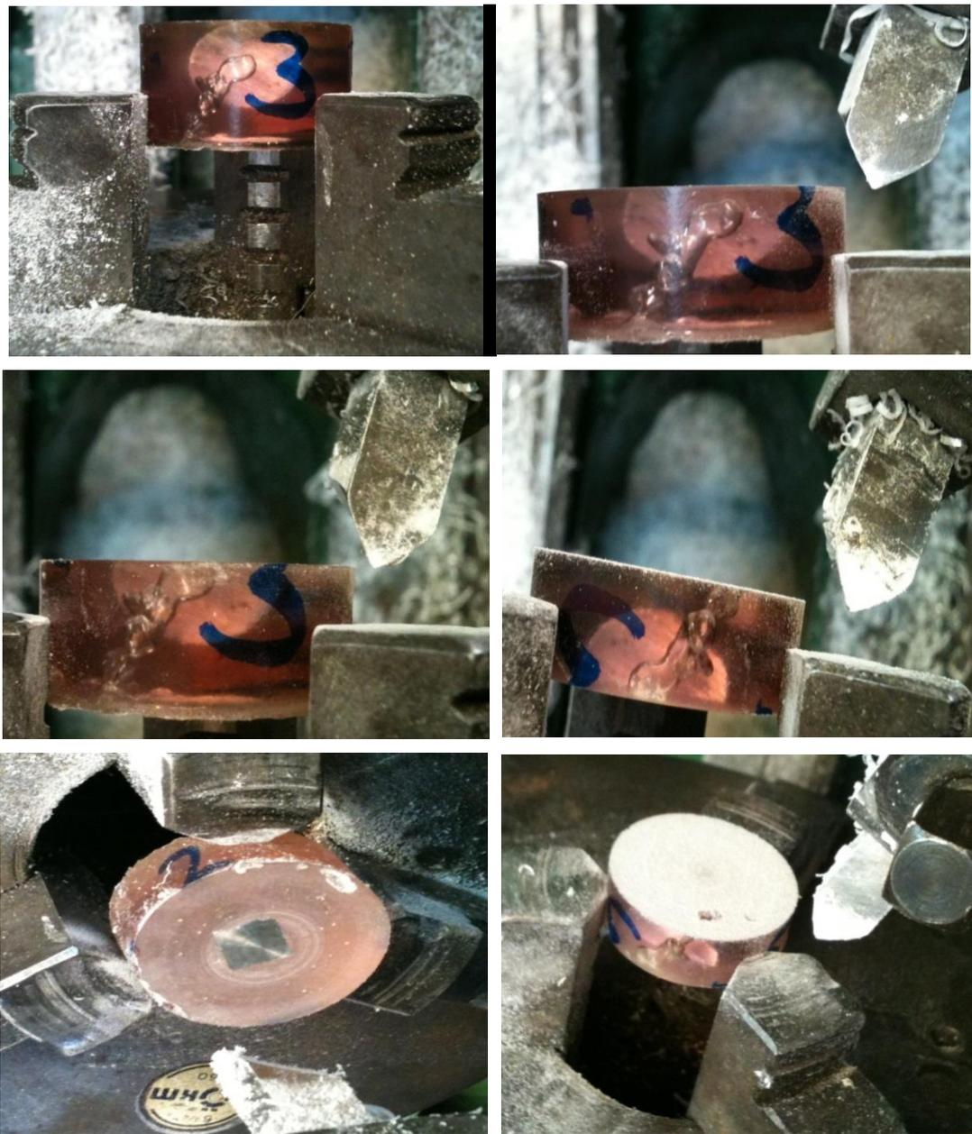
Figura 35. Proceso de desvaste de las probetas montadas en resina.
