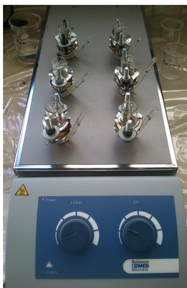
Figura 31. Montaje de las permeaciones.
