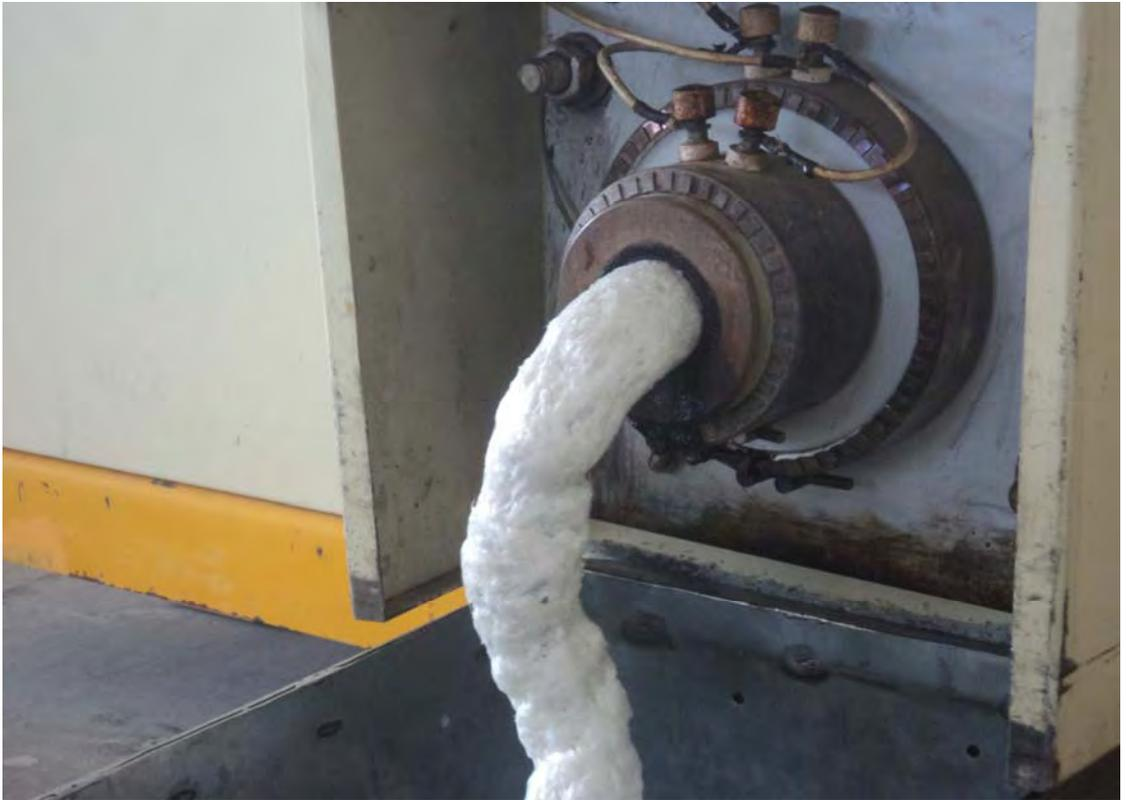
*Ilustración 2-4 Salida del material del dado*
