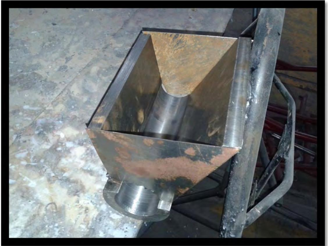
*Ilustración 4-1 Garganta de alimentación tangencial modificada, Barra hueca 3" y Solera de 1/2" AISI 1018*
