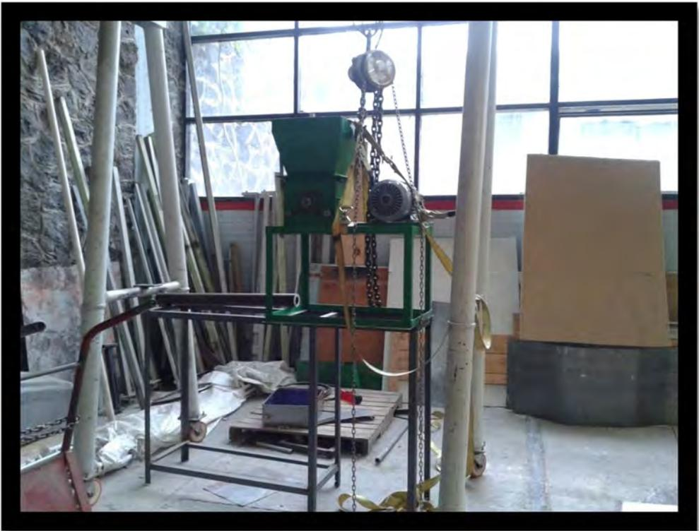
*Ilustración 4-2 Pre ensamble del molino sobre la estructura de la zona de extrusión*
