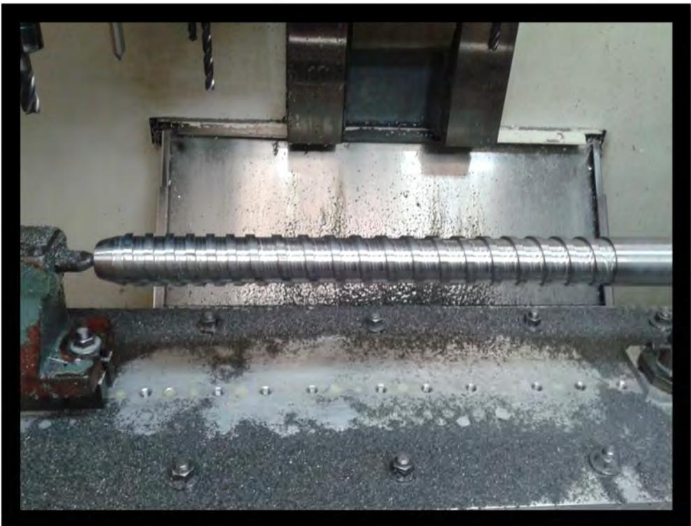
*Ilustración 4-3 Manufactura del husillo, AISI 416, en CNC de 4 ejes (SOMAQ)*
