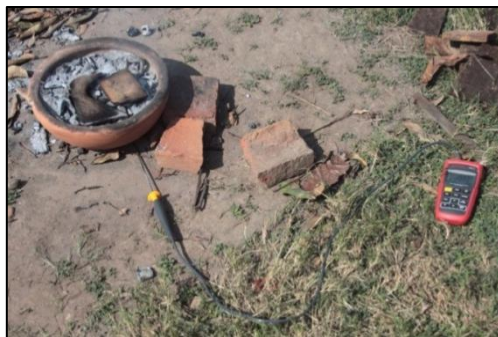
Figura 10. Multímetro y termopar. La Joya. Diciembre 2011. (Archivo personal de la autora).
