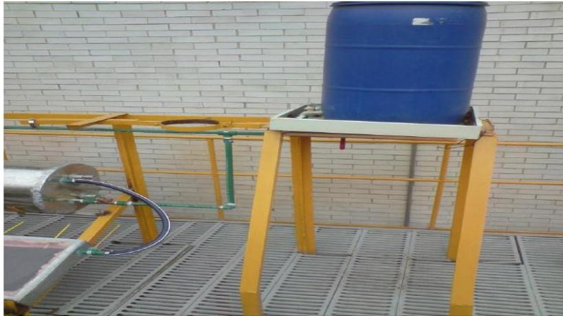
Figura 3.i Tanque de alimentación para el calentador.
