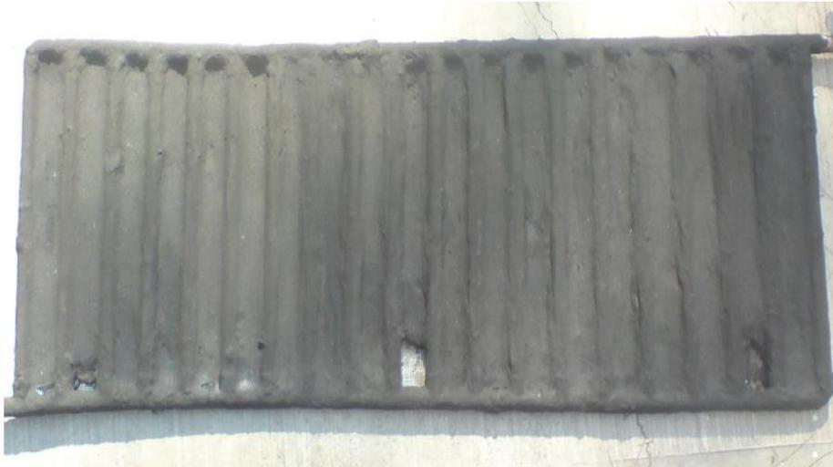
Figura 3.b Placa absorbadora con el recubrimiento terminado.
