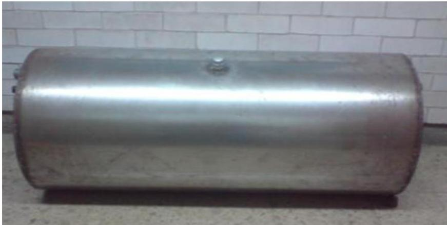
Figura 3.e Tanque de almacenamiento con capacidad para 30 litros.
