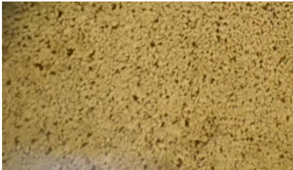
Figura 3.1 Acero 1018 atacado con nital 2 a 50x
