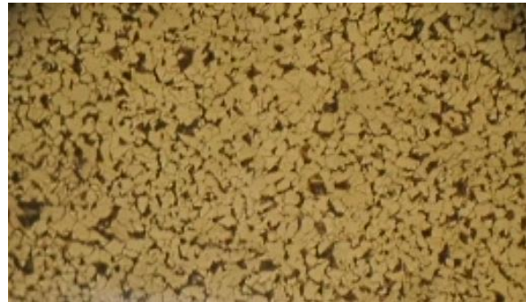
Figura 3.2 Acero 1018 atacado con nital 2 a 100x
