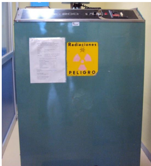
Figura 2.2 Irradiador autoblindado Gammacell-200 con fuentes de ^{60}\text{Co}
