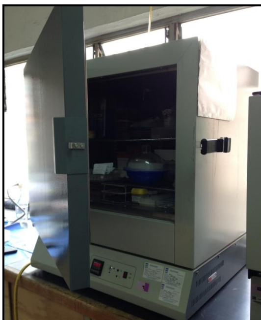
Figura 12. Se colocaron las muestras en el ambientador Felisa a 37°C durante 14 días.
