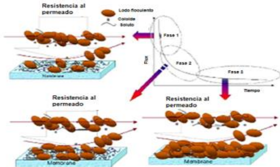
Figura 3.3. Representación esquemática de la formación inicial de cake layer.
