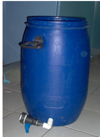
b. Adaptación del reactor UASB
