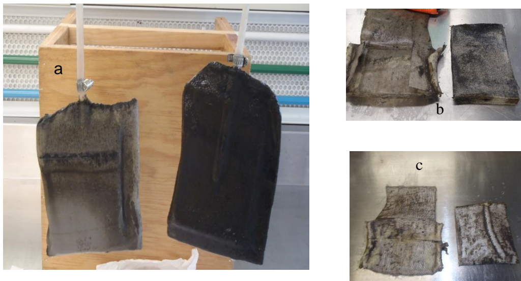
Figura 5.15 Módulos al final de la operación (a) módulo con preformación (b) y (c) sin preformación
