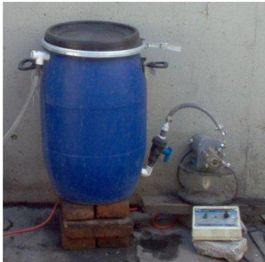
Figura 4.4. Reactor UASB en operación
