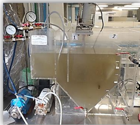
b. Reactor sin preformación
