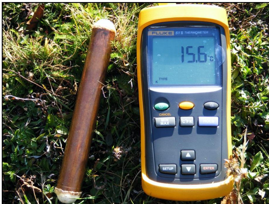
Figura 8. Termómetro Fluke y modelo de cobre utilizado para obtener el registro de las temperaturas operativas ( T^o ). Fotografía de Muñoz-Brito.
