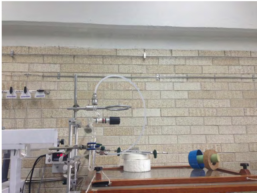
Figura 5.10 Dispositivo para la inyección del concentrado de la atmósfera simulada conectado a una trampa de sosa ensamblado al puerto inyector del cromatógrafo de gases.
