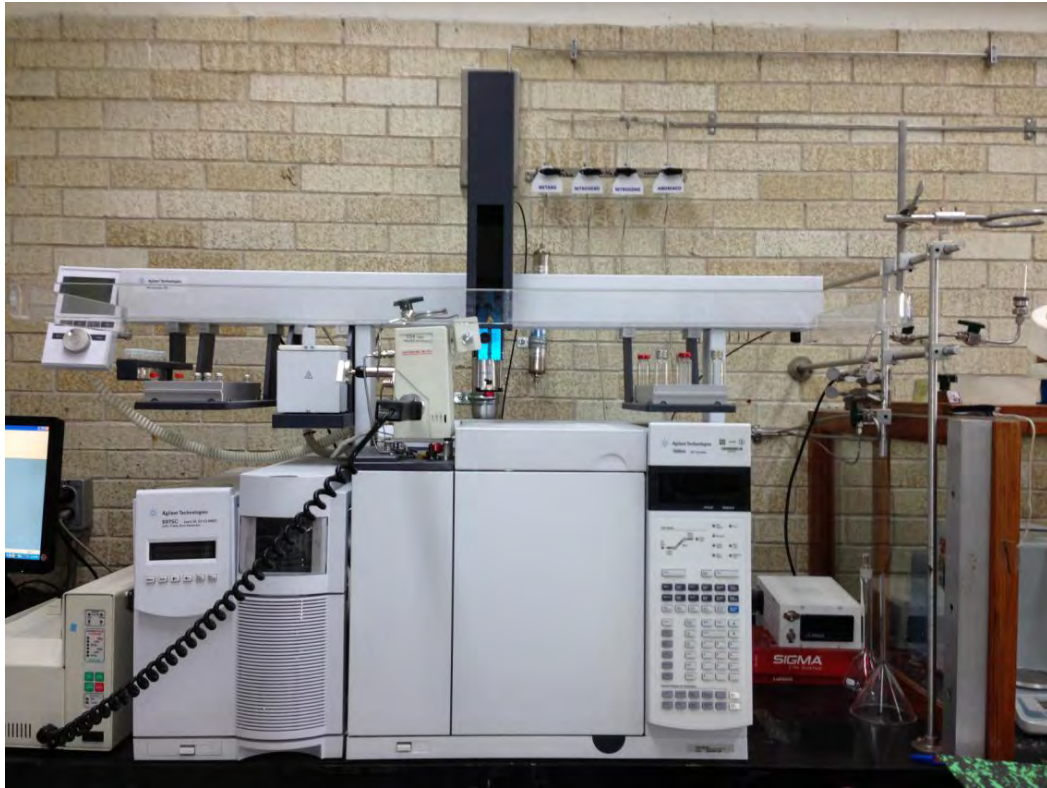
Figura 5.2 Equipo analítico compuesto por un cromatógrafo de gases acoplado a un espectrómetro de masas con válvula automática para el muestreo de gases.
