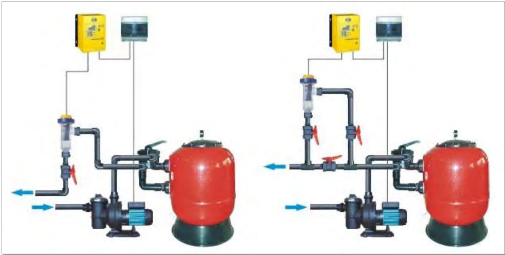
*Esquema de instalación en línea y by-pass*
