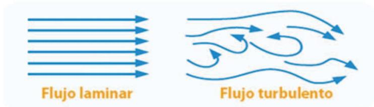
transversales a la dirección principal del flujo; la distribución de la velocidad en el régimen turbulento es más uniforme que a través del diámetro de la tubería que en régimen laminar a
