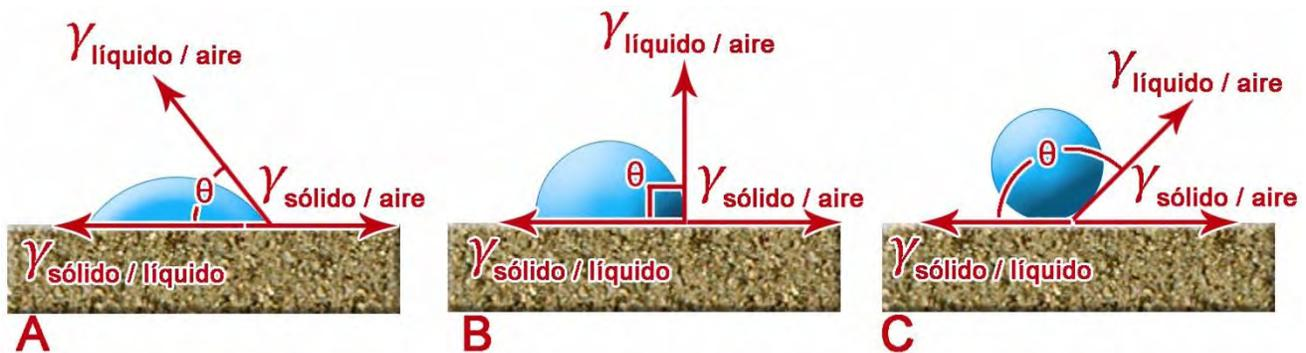
**Fig. 2.1** Gota de un líquido sobre tres diferentes superficies sólidas. De A a C disminuye la atracción por el líquido <sup>[01]</sup>.
