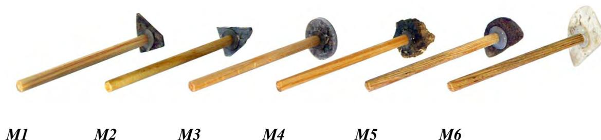
**Figura 4.5** Muestras montadas en varillas de madera.
