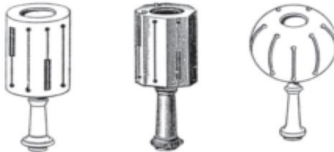
Figura 1.3.7.1 Modelos conocidos de escuadra de agrimensor
