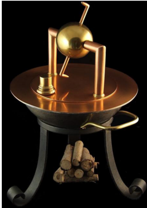
Figura 1.2: Turbina de Herón, turbina de reacción pura. [2]
