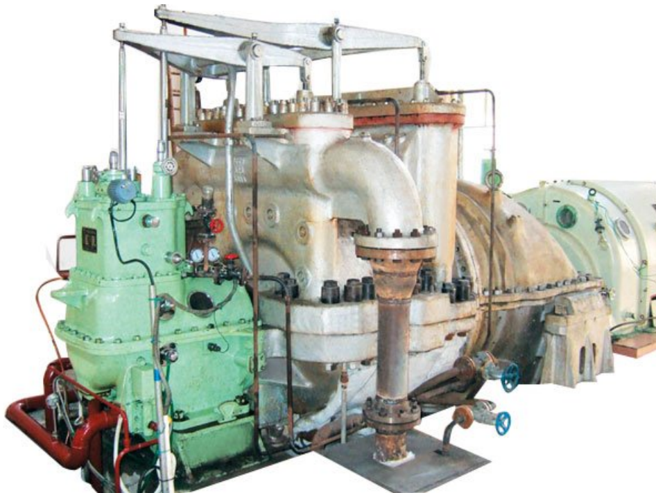
Figura 1.7: Turbina con extracción de vapor [7].
