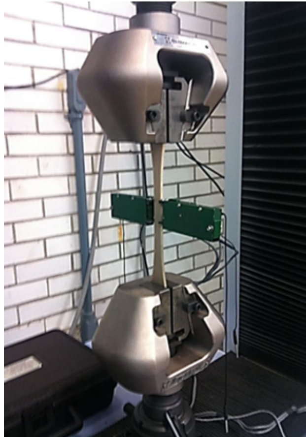
Figura 3.13: Máquina de ensayos Shimadzu AG-X y extensómetro mecánico (dispositivo en color verde).
