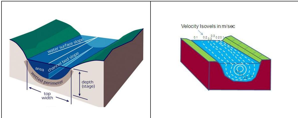
Figura 5. 9 Características geométricas e hidráulicas de un canal
