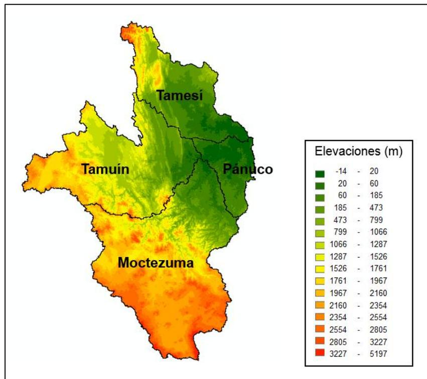
Figura 2.5 Modelo Digital de Elevaciones con resolución a cada 15 metros de la región del Pánuco (INEGI, 2014)
