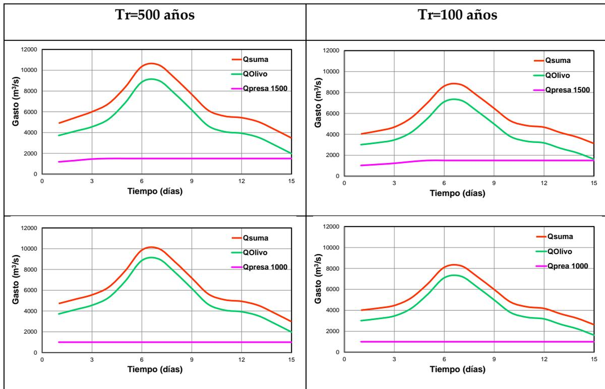
Figura 4. 5 Hidrogramas de los gastos de diseño del río Pánuco asociado a los periodos de retorno de 500 y 100 años. En color naranja se indica la curva del gasto que se ingresa a la Estación de las Adjuntas, resultado de sumar los gastos de la Estación Olivo (curva verde) y la descarga de la Presa Pujal-Coy (curva rosa)
