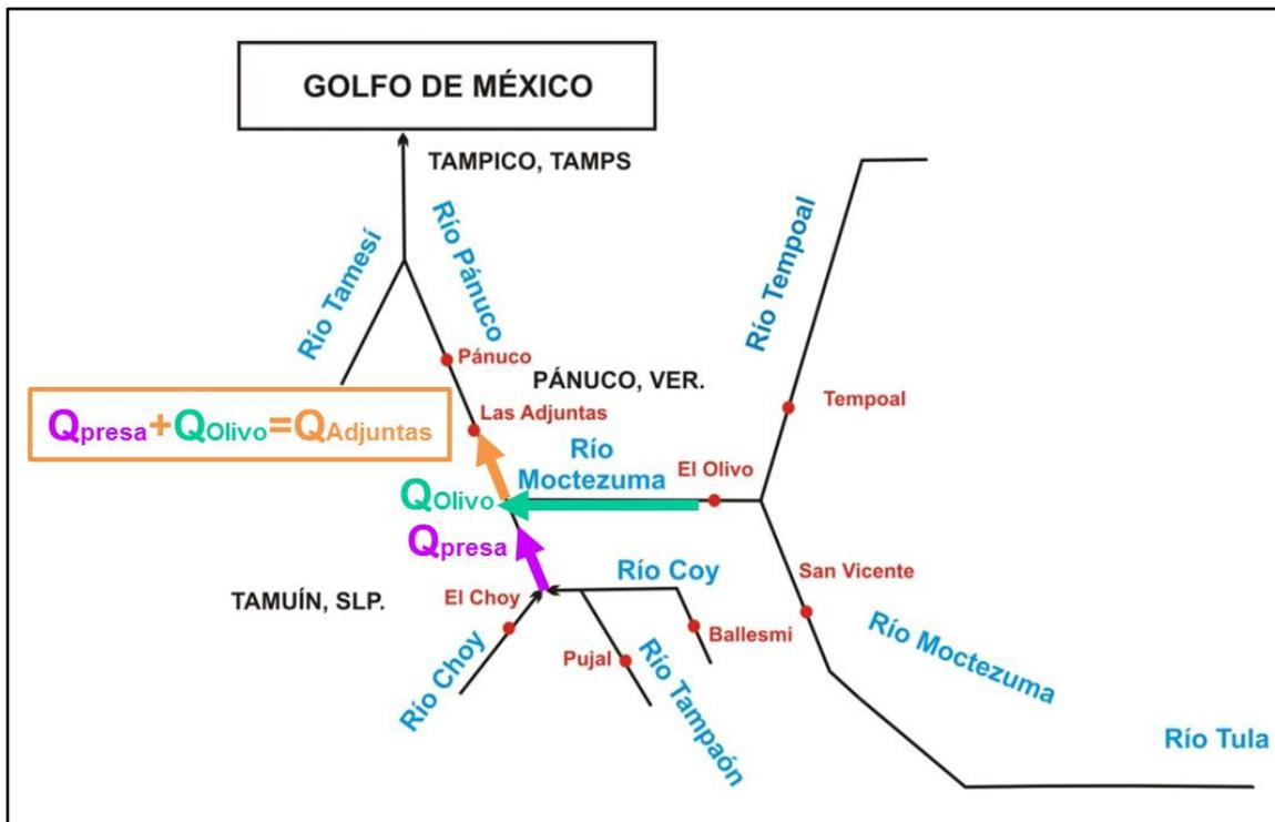
Figura 4. 4 Esquema de los gastos que se ingresan a la Estación de las Adjuntas (flecha naranja) que pertenece al río Pánuco, obtenido a partir de la suma entre los gastos de la Estación Olivo (flecha rosa) y el gasto regulado por la Presa Pujal-Coy (flecha verde)
