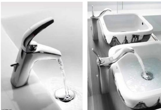
El grifo con monomando es un grifo mezclador en el que la apertura, cierre y mezcla del agua se efectúa mediante una sola palanca. Funcionan moviendo la palanca en dos sentidos: desplazándose hacia arriba se abre progresivamente el grifo y accionándola hacia abajo se cierra. Girando la palanca de derecha a izquierda se obtiene gradualmente agua fría, tibia y caliente.
