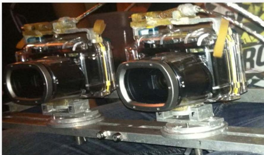
**Figura 47. Mecanismo de disparo sincronizado de las cámaras: El disparo se efectúa de manera mecánica con un sistema de chicotes y pasadores, el cual activa la toma de imágenes de manera simultánea.**
