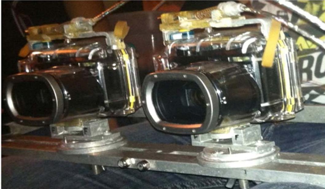
**Figura 3. Mecanismo de disparo sincronizado de las cámaras:** El disparo se efectúa de manera mecánica con un sistema de chicotes y pasadores, el cual activa la toma de imágenes de manera simultánea.
