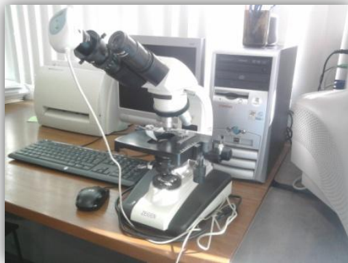
Figura 33. Microscopio ZEIGEN con cámara MOTICAM 1000 (1.3 MP Live Resolution).
