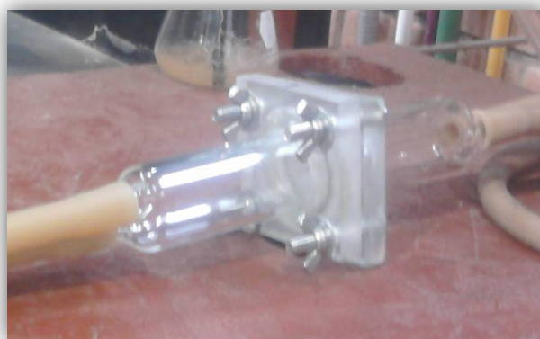
Figura 21. Celda de transporte de gas para la medición de permeabilidad al oxígeno.
