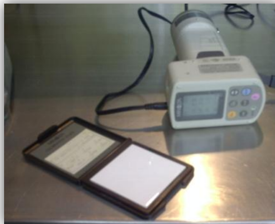
Figura 31. Colorímetro Minolta CR 400.
