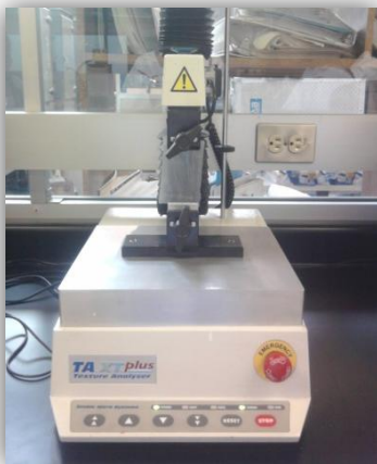
Figura 26. Texturómetro TA XT Plus, Texture Analyser.
