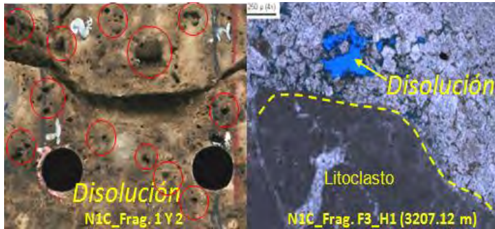
Figura III.4.1.3. Núcleo 1C (3207-3209 m) Porosidad secundaria generada por procesos de disolución.
