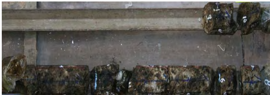
Figura III.4.1.7. N1 (3202-3207, Rec. 1.40 m) Impregnación de hidrocarburos.
