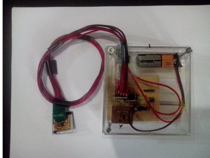
Se trata de un dispositivo que utiliza como fuente de energía una pila de 9 volts, manda la información vía Bluetooth a una computadora en donde se traducen los datos mediante el programa Matlab versión R2012b. Para mayor referencia consultar la referencia 22.
