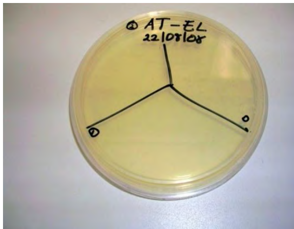
Figura 25. División de las cajas para siembra en superficie para la determinación de BAT
