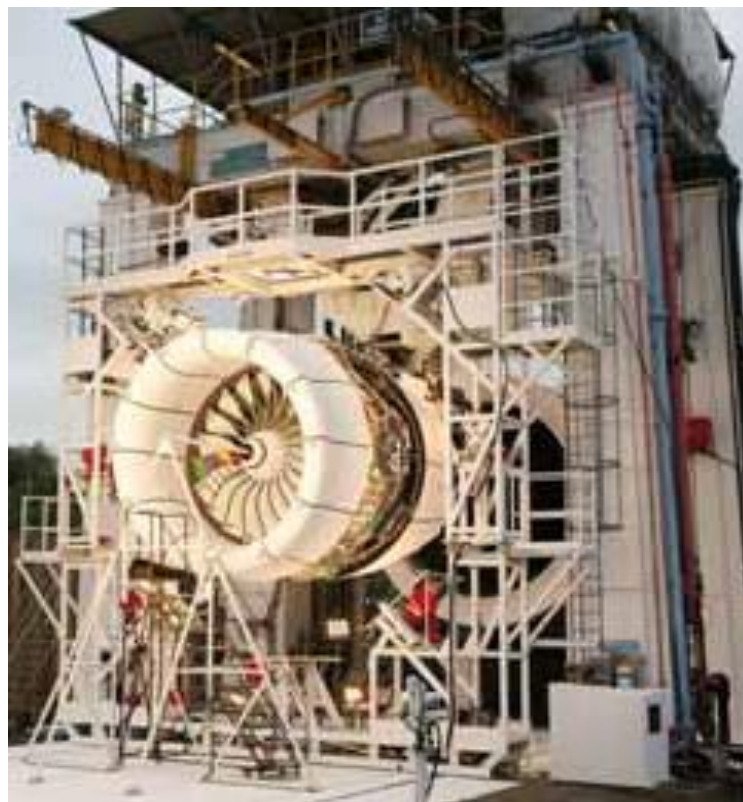
Figura 2.3: Prueba de pérdida de un álabe en una turbina de Avión, cortesía de Rolls Royce Limited Co. 38
