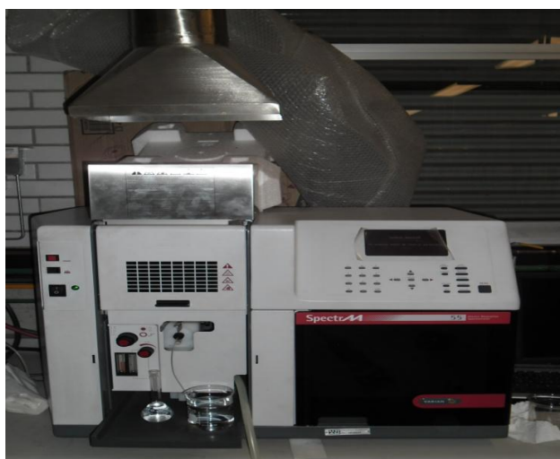
Figura 11. Espectrofotómetro de Absorción Atómica. Equipo utilizado para la cuantificación de selenio en las formulaciones elaboradas.
