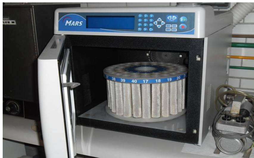
Figura 10. Microondas para digestión ácida. Equipo empleado para la digestión de las microesferas para retirar la materia orgánica y dejar únicamente el selenio para su cuantificación.
