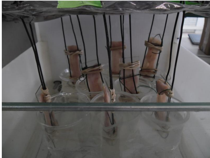
Figura 9. Aparato de cuantificación mucoadhesiva múltiple. Este aparato fue diseñado para facilitar los estudios de mucoadhesión ya que permite realizar 8 determinaciones simultáneas con el desintegrador de la USP.
