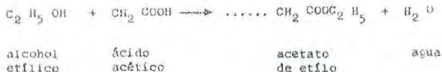
A fin de obtener un buen rendimiento en la reacción química, es necesario que las moléculas sean extraídas del recipiente donde se efectúa la reacción, evitando en esta forma una transformación o reacción reversible conocida como hidrólisis.
